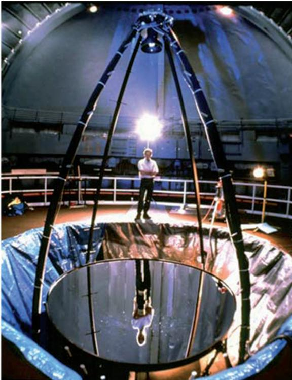
Рис. 1.3.19. Трёхметровый телескоп НАСА с жидким зеркалом
