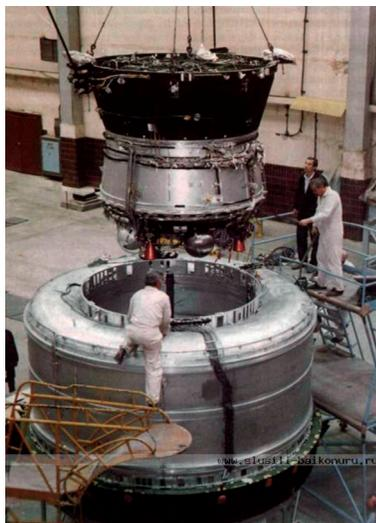
**Рис. 3.2.15.** Центральный бак ступени «Бриз-М» и главный двигатель, вставляемый во вспомогательный топливный бак [404]
