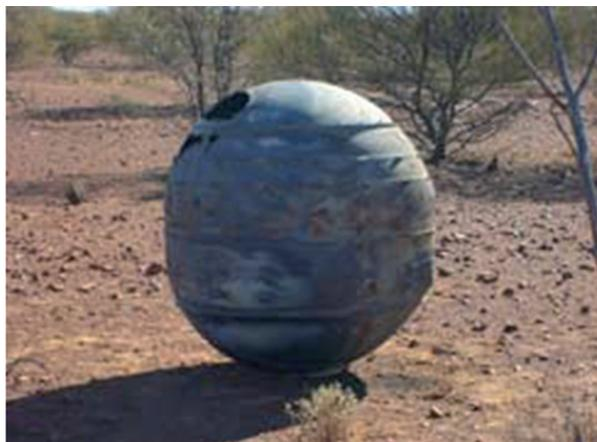
**Рис. 3.1.7.** Найденный в Австралии кожух твердотопливного двигателя третьей ступени РН «Дельта-2»
