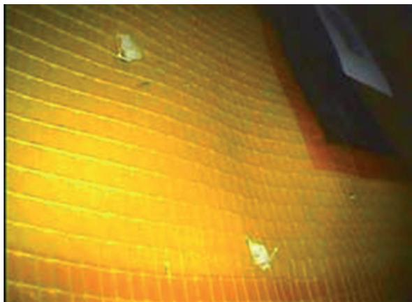
**Рис. 3.1.28.** Повреждения термозащитного одеяла под панелью радиатора
