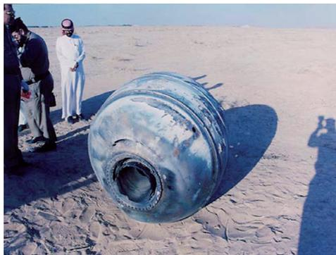
**Рис. 3.1.4.** 70-килограммовый главный титановый кожух твердотопливного двигателя верхней ступени РН «Дельта», найденный в 240 км от Эль-Рияда [302]
