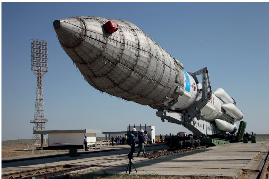
**Рис. 3.2.5.** Ракета-носитель «Протон-М» с разгонным блоком «Бриз-М»
