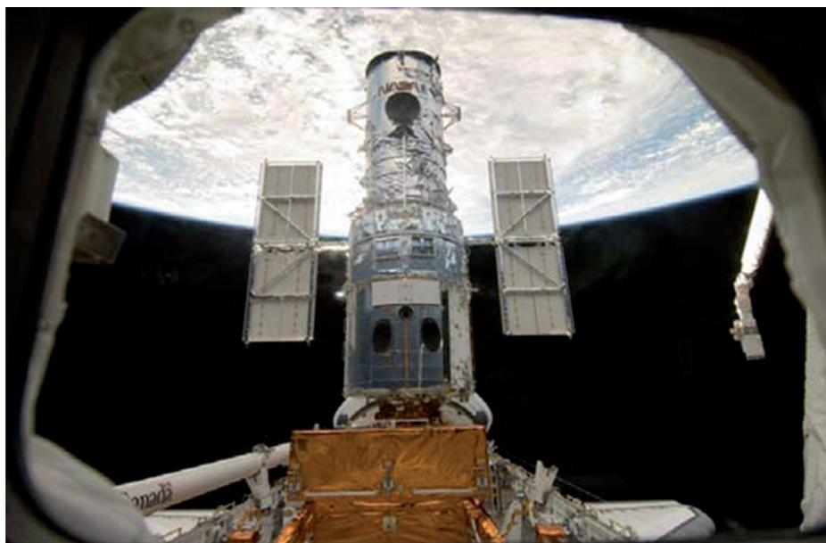
**Рис. 3.1.16.** В центре — радиатор камеры 2, возвращённый на Землю. Снимок сделан из грузового люка шаттла «Атлантис» (англ. Atlantis), пристыкованного к HST
