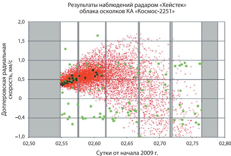
**Рис. 1.3.8.** Измерения «Хейстека» и моделированное облако осколков. Иллюстрация последствий столкновения КА «Иридиум-33» и «Космос-2251»
