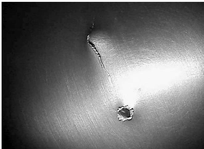
**Рис. 3.1.26.** Пробоина и трещина на панели радиатора шаттла миссии STS-115
