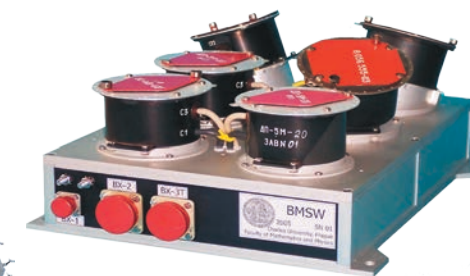
Комплекс ПЛАЗМА-Ф для исследований солнечного ветра на борту космической обсерватории СПЕКТР-Р
