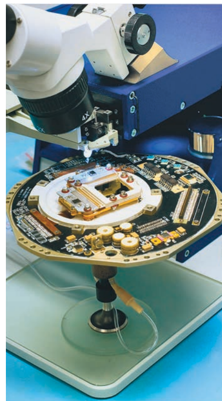
Сборка полупроводниковых детекторов телескопа ART-XC им. М.Н. Павлинского
