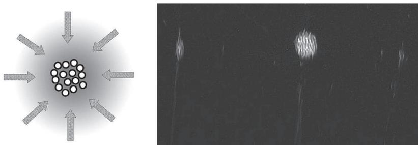
**Рис. 6.** Плазменно-пылевой кластер обжимается плазменными потоками, рекомбинирующими на поверхности микрочастиц (слева). Прямое наблюдение плазменно-пылевого кластера, сформированного плазменными потоками на поверхность микрочастиц (справа). Размер кластера около 1 мм
