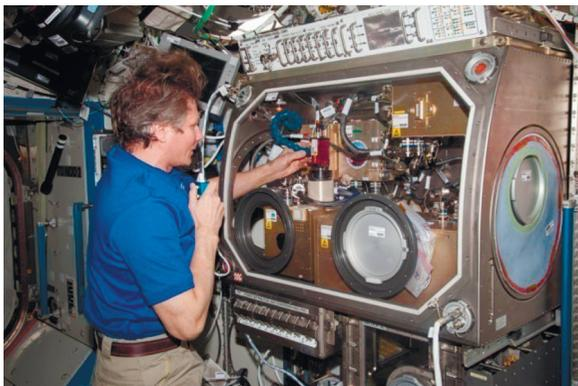
**Рис. 1.** Геннадий Падалка устанавливает видеокамеру, используемую для регистрации изображений образцов в космическом эксперименте OASIS, американский сектор МКС (Glenn Research Center, NASA, <https://www1.grc.nasa.gov/space/iss-research/msg/oasis/>)
