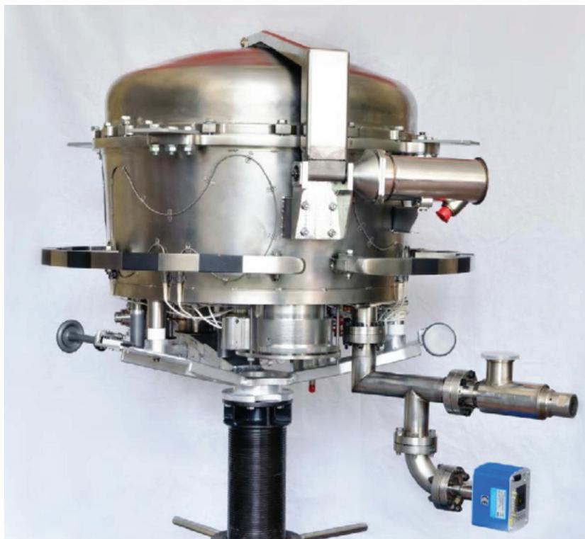
Рис. 2. Внешний вид опытного образца установки МЛЭ
