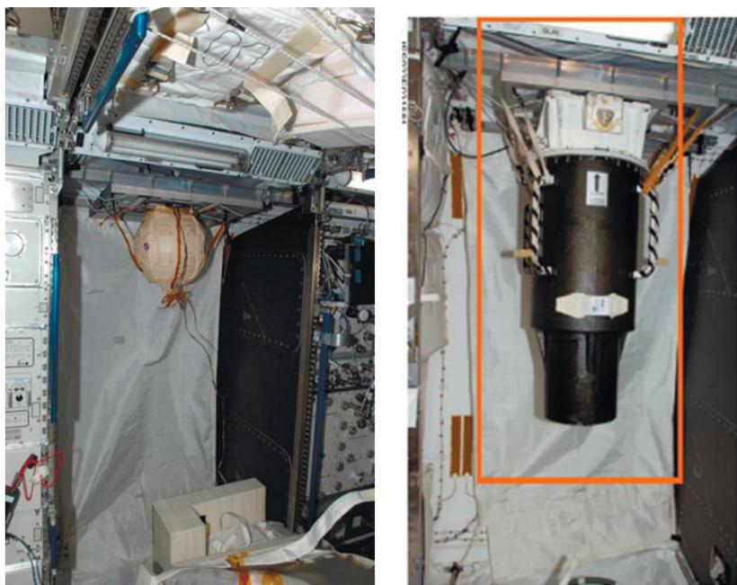
**Рис. 1.** Шаровой (слева) и антропоморфный (справа) фантомы в модуле «Кибо» МКС
