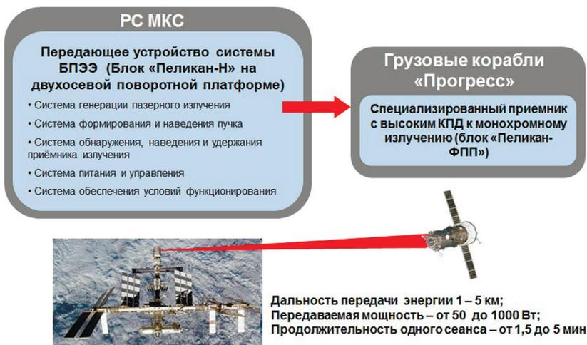
Рис. 1. Схема проведения КЭ «Пеликан»
