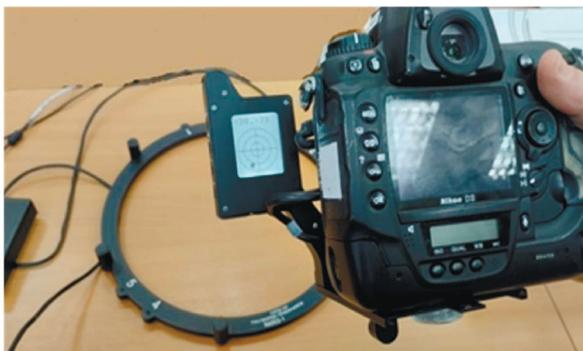
**Рис. 4.** Жидкокристаллический малогабаритный экран с меткой отклонения центра кадра от направления на заданный объект
