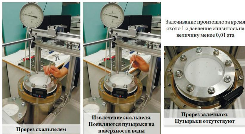
**Рис. 3.** Демонстрация залечивающих свойств макета слоистого компози-
