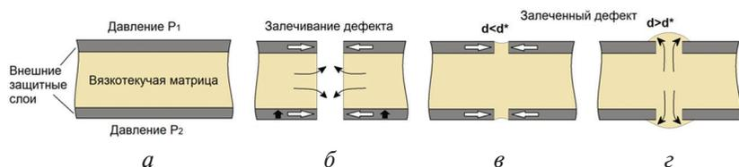
**Рис. 1.** Механизм самозалечивания в слоистых материалах с внутренним вязкотекучим наполнителем
