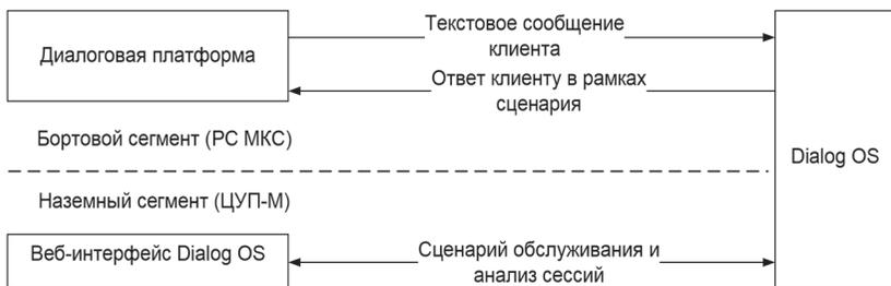
**Рис. 1.** Информационная модель использования Dialog OS в космическом эксперименте «Ассистент»
