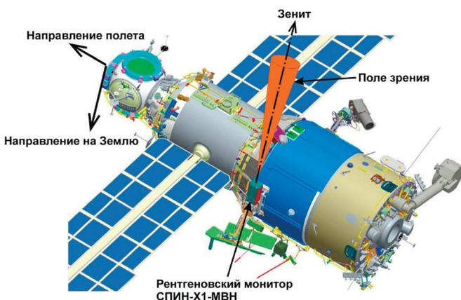
Рис. 3. Размещение монитора СПИН-Х1-МВН на МКС
