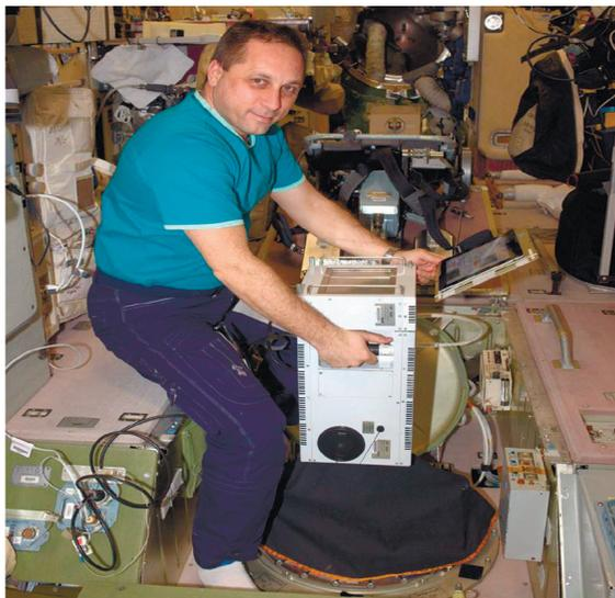
**Рис. 1.** Видеоспектральная система (ВСС). Космонавт А. Шкаплеров ведёт съёмку с помощью ВСС
