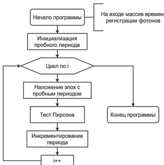
Рис. 2. Блок-схема алгоритма поиска периода при помощи метода наложения эпох
