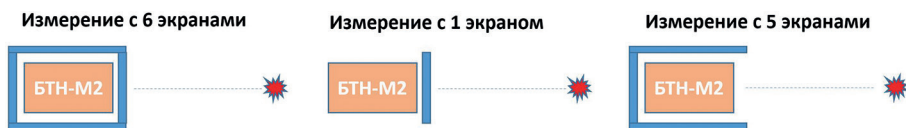
Рис. 5. Схема измерений с СЗЭ
