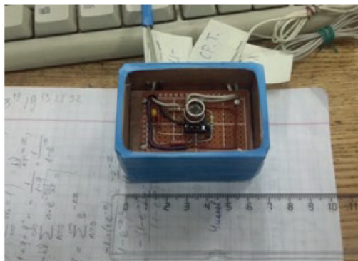
Рис. 1. Общий вид датчика и оценка его габаритов. Передняя крышка снята
