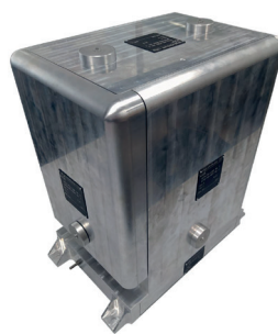
Рис. 2. Лётный образец БТН-М2 со смонтированными СЗЭ
