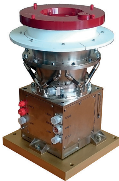
Рис. 1. Звёздный датчик со статическим имитатором
