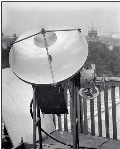
Рис. 25. Антенна Кассегреновского типа на длину волны 1,5 см (фотография предоставлена В. В. Крыловым)
