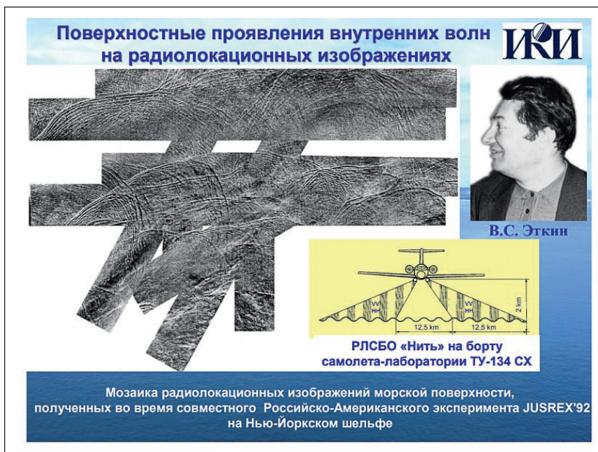
Рис. 19. Композитный снимок поверхностных проявлений внутренних волн в Гудзоновом заливе, составленный по данным радиолокатора бокового обзора «Нить» самолёта-лаборатории Ту-134СХ (снимок предоставлен О. Ю. Лавровой )
