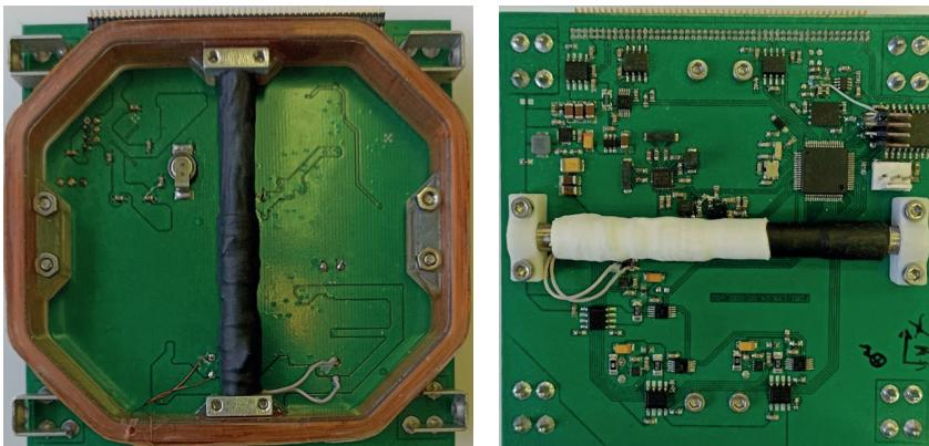
**Рис. 1.** Инженерная модель модуля электромагнитной ориентации (вид с обеих сторон)
