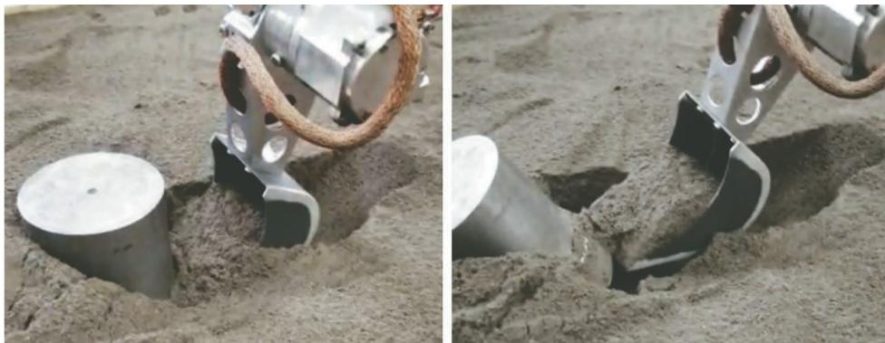
Рис. 7. Имитация соприкосновения с тяжёлым объектом (камнем или куском породы)
