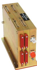
Видеокамера 4К, 20°, 55° или 110°, моно/цвет, LVDS/SpaceWire, 1,5 Вт, 150–300 г
