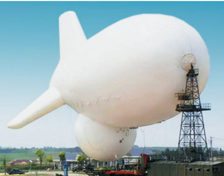
Привязной аэростат ПУМА на стоянке в КНР
