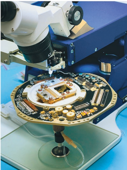
Сборка полупроводниковых детекторов телескопа ART-XC им. М.Н. Павлинского
