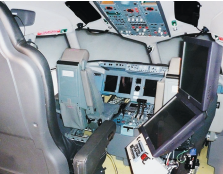
Кресло инструктора в кабине тренажёра
