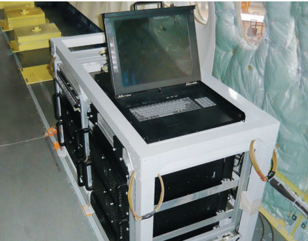
Рама с АРМ СБИ в салоне опытного самолёта
