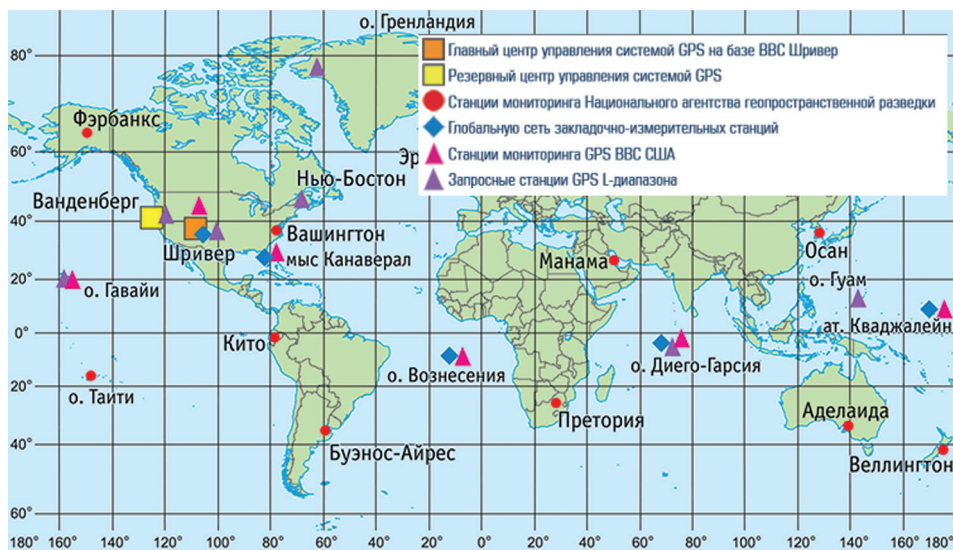
Рисунок 34. Наземный комплекс управления GPS [33]
