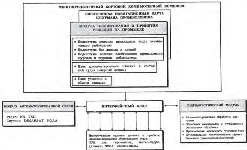
Рисунок 1.3. Принципиальная структурно-функциональная блок-схема бортовой мониторинговой компьютерной системы
