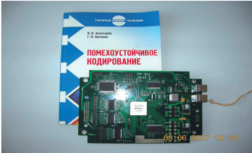
Рис. 4. Действующий макет МПД декодера на ПЛИС Altera для гауссовского канала на информационную скорость 1 Гбит/с, созданный в ИКИ РАН
