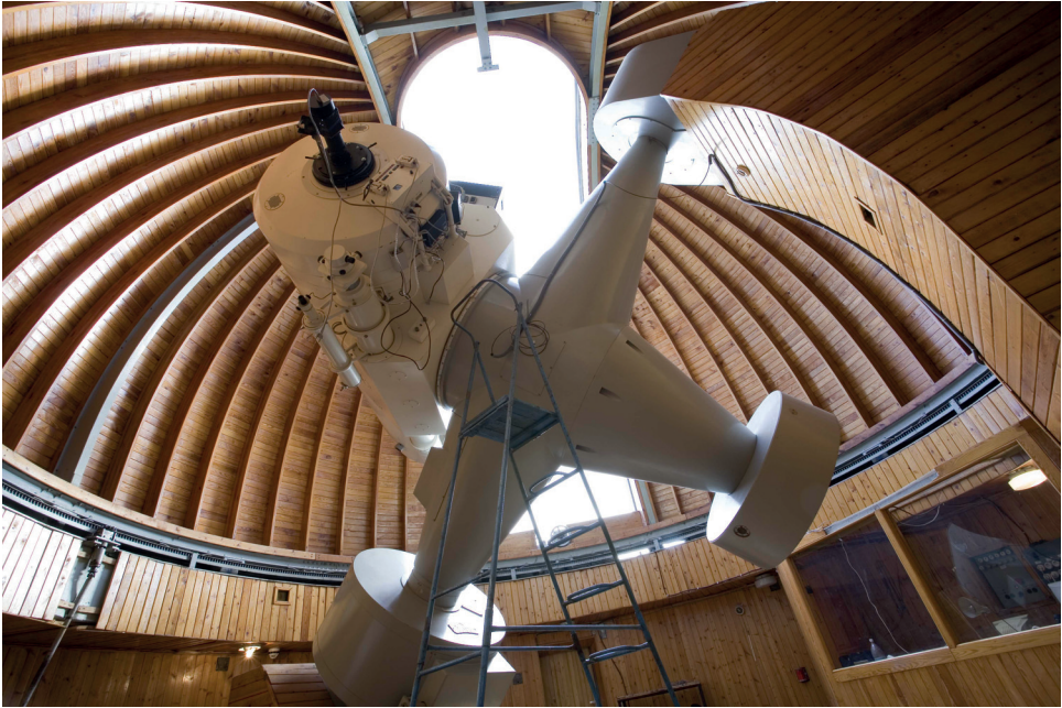
Рис. 1. Однометровый зеркальный телескоп предприятия Carl Zeiss Jena с установленным на нём поляриметром ИКИ РАН
