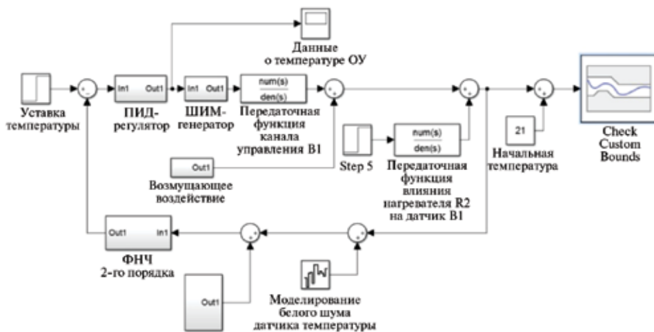
Рис. 9. Моделирование одного канала управления в Simulink для расчёта оптимальных коэффициентов ПИД-регулятора
