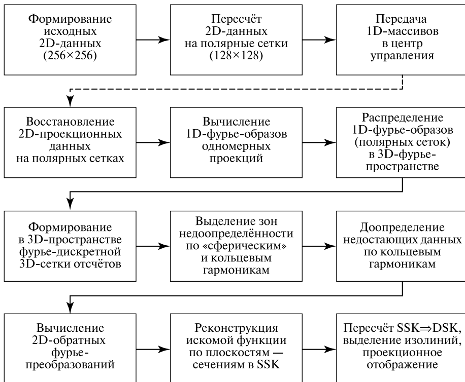
Рис. 2. Иллюстрация порядка выполнения вычислительных операций по реконструкции искомого 3D-распределения
