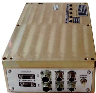
Рис. 12. Блок предварительной обработки данных
