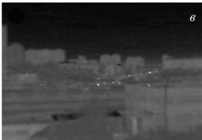
Рис. 14. Совмещение изображений, полученных ИК-каналом гиперспектретра (а) и тепловизором (б). На изображении (в) показан совмещённый снимок
