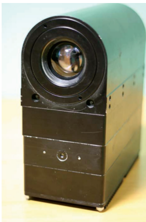
Рис. 8. Ультрафиолетовый сенсор «Корона»
