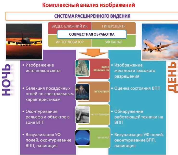
Рис. 7. Комплексный анализ изображений в системе расширенного видения, предназначенной для нужд авиации
