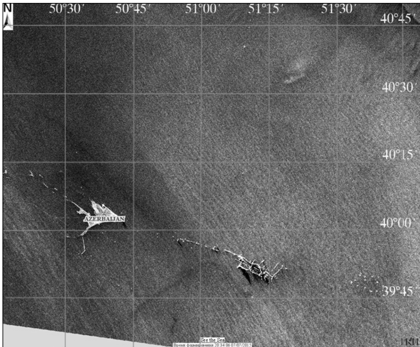
Рис. 5.4. Фрагмент РЛИ Sentinel-1A SAR от 18 марта 2015 г., 02:43 UTC, полученного над районом нефтедобычи Нефтяные Камни. Относительно небольшое нефтяное загрязнение морской поверхности площадью около 4 \text{ км}^2 , идентифицируется в непосредственной близости от нефтедобывающей платформы
