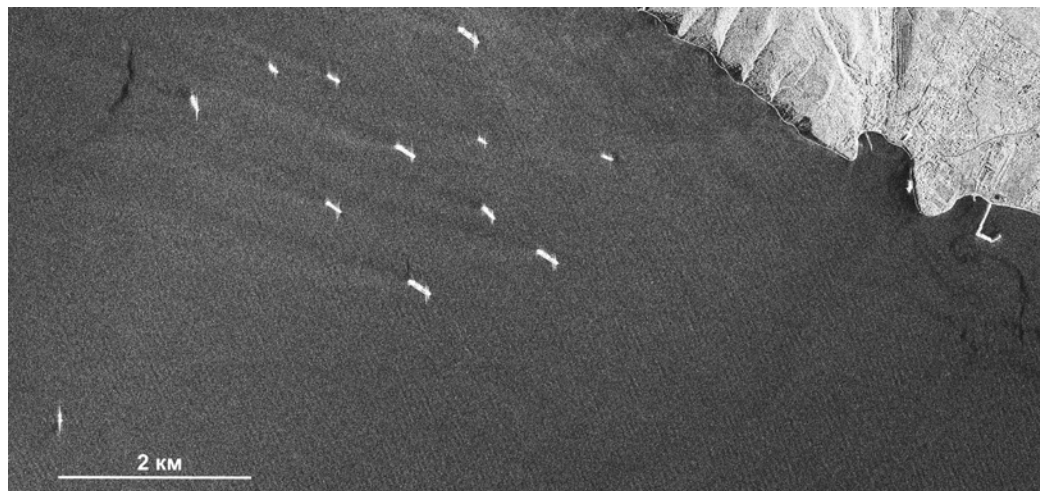
Р и с. 2.8. Проявление нефтяного загрязнения, биогенных slickов и судов на радиолокационном изображении Radarsat-2, полученном в режиме Ultra-Fine 11 октября 2011 г. Фрагмент 11×5 км, пространственное разрешение 3 м, ВВ-поляризация
