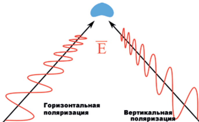
Р и с. 2.1. Вектор электрического поля при горизонтальной и вертикальной поляризации зондирующего сигнала
