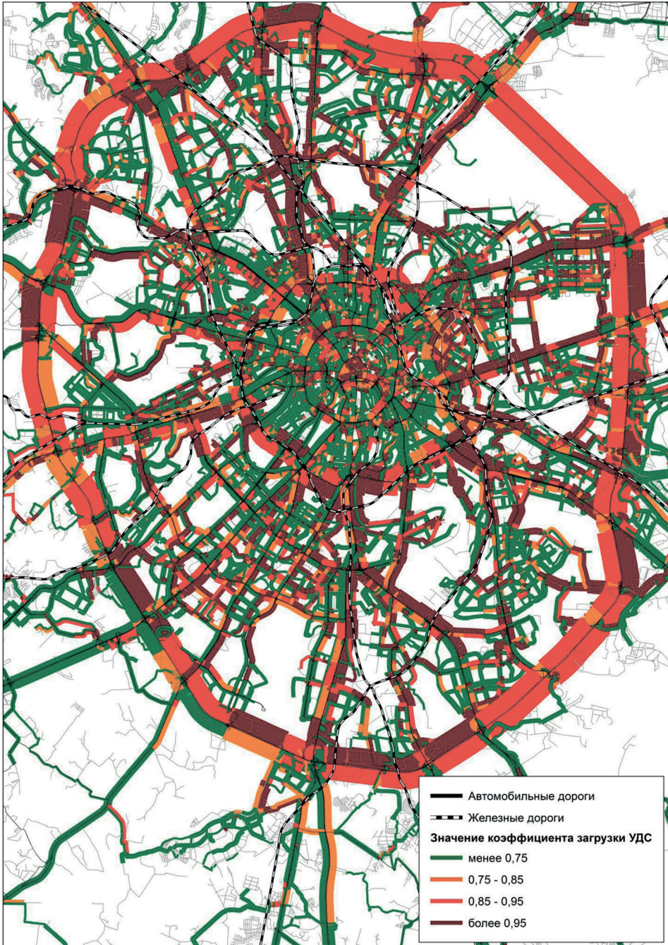
Рис. 4. Транспортные потоки на рёбрах графа УДС. Толщина линии пропорциональна загрузке ребра. Результаты моделирования
