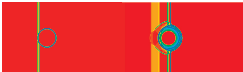
Рис. 2. Цифровой шпирен для градиента плотности при t = 0 (слева) и при t = 7 (справа)
