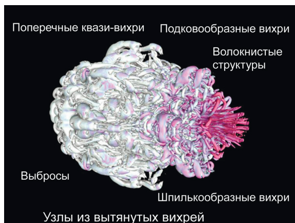
Рис. 7. Неустойчивость Рихтмайера-Мешкова — интенсивное вихреобразование — фрагментация по плотности газа облака после прохождения ударной волны
