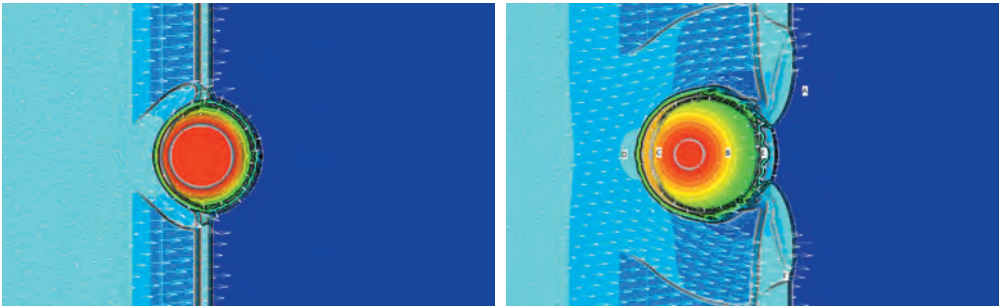
рис. 1. Векторное поле течения в сечении z = 1/2 для двух моментов безразмерного времени
