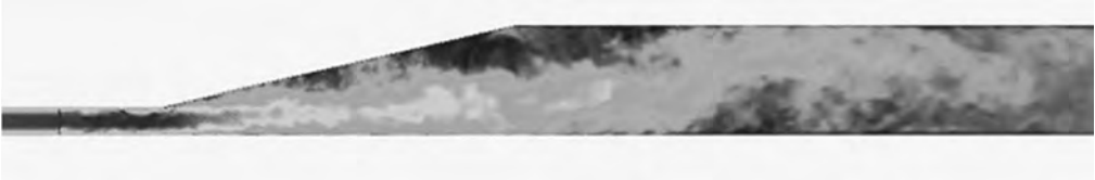
б) Использование EARSМ-LES с генератором синтетической турбулентности рис. 3. Мгновенное поле скорости
