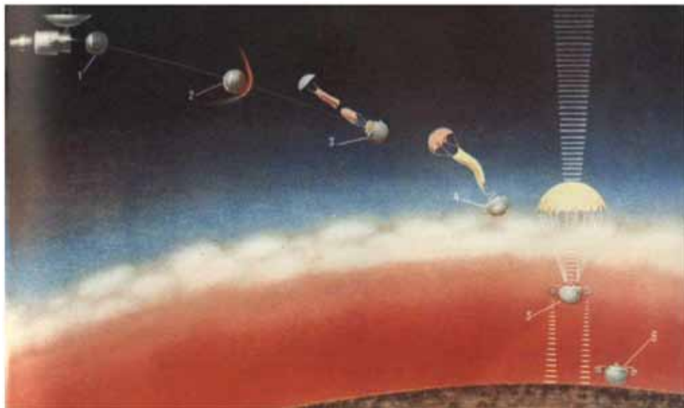
Рис. 3. Вход в атмосферу и парашютный спуск станции «Венера-4», впервые в мире измерившей параметры атмосферы Венеры (температуру, давление, химический состав)
