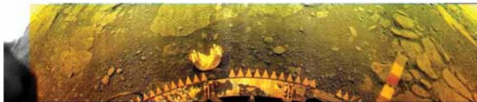
Рис. 15. Цветная панорама поверхности Венеры (в современной обработке) в точке посадки аппарата «Венера-13», составленная из цветоделённых изображений 1R, 1G и 1BW [Ксанфомалити, 2012а], время 0...38 мин с момента включения. Зубчатая «корона» внизу — посадочный буфер аппарата, в центре — сброшенная полуцилиндрическая крышка камеры 1. Помехи и шумы на изображениях практически отсутствуют
