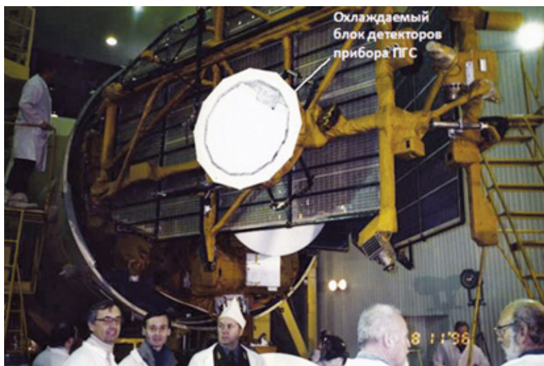
Рис. 1. Космический аппарат «Марс-96» на Байконуре перед установкой головного обтекателя, 8 дней до старта. Стрелкой показан охлаждаемый блок детекторов прибора ПГС
