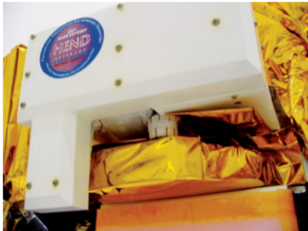
Рис. 7. 16 марта 2001 года. Второй лётный образец российского прибора ХЕНД на борту аппарата «Марс Одиссей» готов к полёту. Под посадочной лапой прибора видна рессора в шубке из термоизоляции
