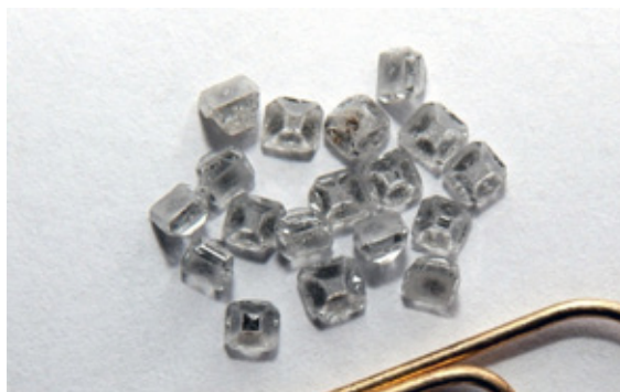
Рис. 20. Алмазные ударники для группового метания. Ударники были выращены из тринадцатого изотопа углерода в Технологическом институте сверхтвёрдых и новых углеродных материалов в Москве
