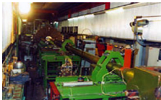
Рис. 21. Многоцелевая модельная баллистическая установка ЦНИИмаш была использована как метательная машина ударников, обеспечивающая скорость удара 7 км/с
