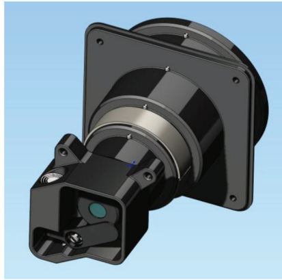
Рис. 5. Калибровочный затвор в открытом состоянии
