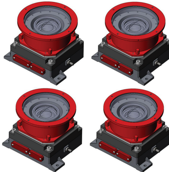
Рис. 2. Обзорные камеры для системы технического зрения посадочного модуля «Луна-Глоб»
