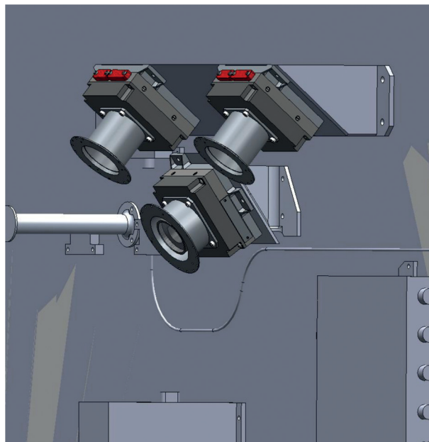
Рис. 2. Размещение стереокамер СТС-Л в приборном отсеке
