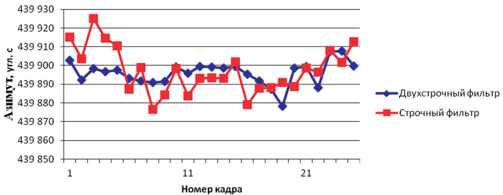
Рис. 19. Разброс параметра «Азимут» между кадрами в статике: строчный фильтр, СКО_{аз} = 12,2 угл. с; двухстрочный фильтр, СКО_{аз} = 6,33 угл. с
