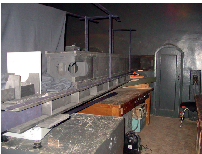
Рис. 2. Внешний вид коллиматора для стенда исследования бленд
