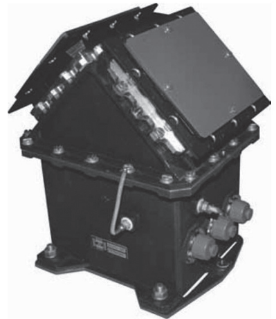
Рис. 2. Солнечный датчик БОКС-01 разработки НПП «Оптэкс» с двумя оптическими головками
