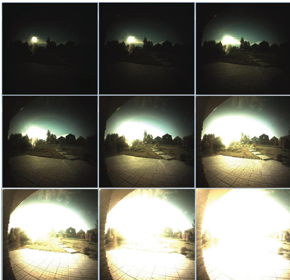
Рис. 18. Кадры из серии снимков для получения изображения с большим динамическим диапазоном. Выдержка от 0,24 до 63 мс, каждая следующая выдержка больше предыдущей в два раза
