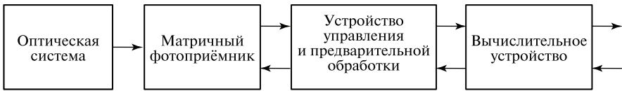
Структурно-функциональная схема звёздного прибора
