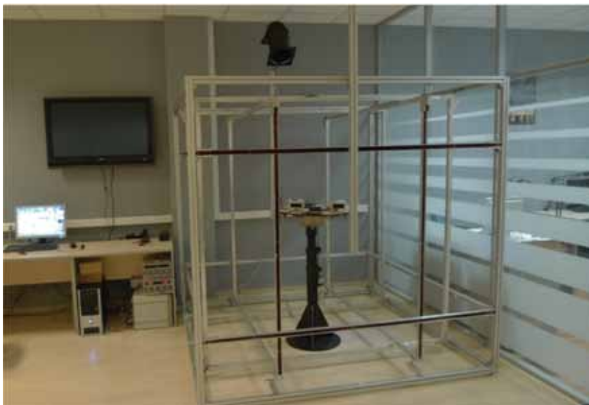
Рис. 10. Стенд для полунатурных испытаний системы ориентации и стабилизации микроспутника «Чибис-М»
