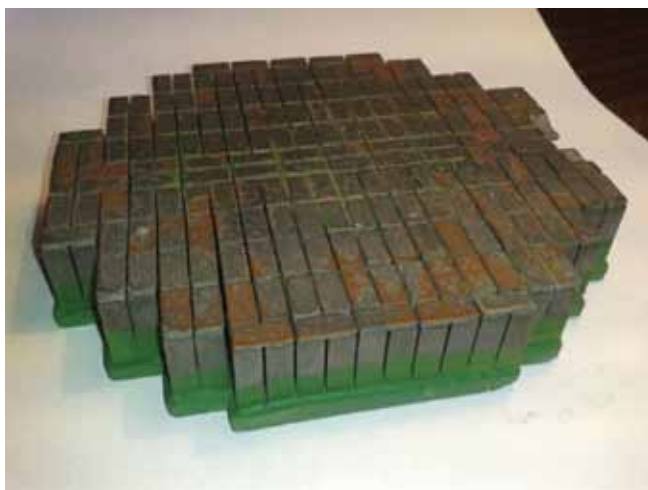
Рис. 1. Термобатарея для ИЗОТЭГ «Жизнь2». Мощность 20 Вт, напряжение 10 В, КПД 10 %
