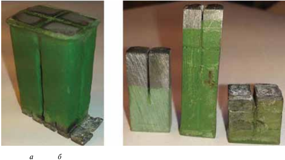
Рис. 8. Высокоэффективные термоэлементы: а — термоэлектрический многоступенчатый модуль из четырёх термоэлементов; б — термоэлементы для различных тепловых потоков
