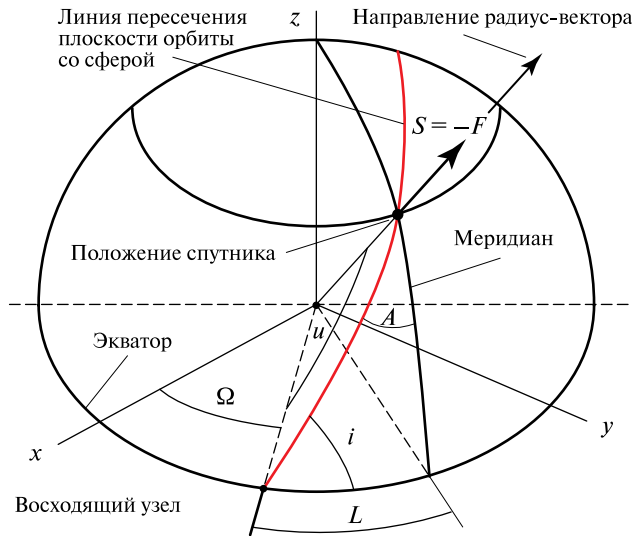
Рис. 4.2. Положение плоскости орбиты в инерциальной системе координат
