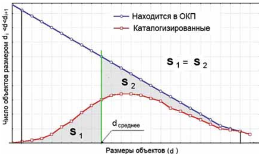
Рис. 3.3. Схема определения среднего минимального размера КО в каталоге
