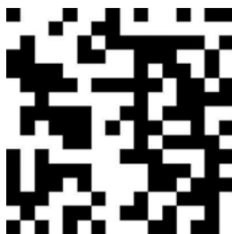
Рис. 3. Конфигурация маски САМ, используемой в модуле СЗТ. Методика генерации шаблона обсуждается в [Nandi et al., 2011]
