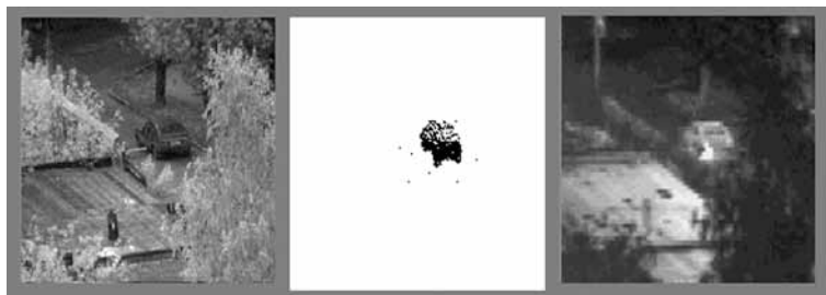
Рис. 9. ТВ-, ЛЛ- и ИК-изображения движущегося объекта на малой дальности (150 м)
