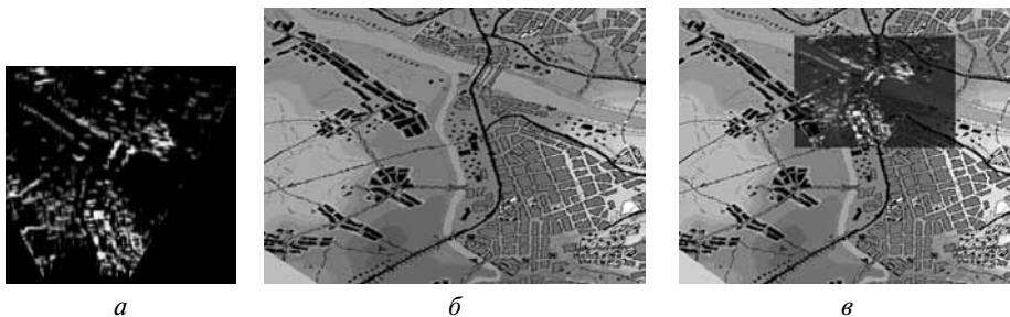
Рис. 9. Привязка РЛИ к ЦКМ: а — РЛИ; б — ЦКМ; в — результат привязки
