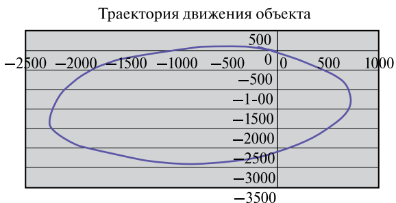
Рис. 10. Работа с оптическим потоком в земных условиях. Слева — пример выделения векторов смещения в поле зрения вперёдсмотрящей камеры, установленной на автомобиле; справа — результат бесконтактной одометрии на кольцевом маршруте. Единица измерения по осям — 0,2 м. Полученная точность 0,2 % от пройденного маршрута
