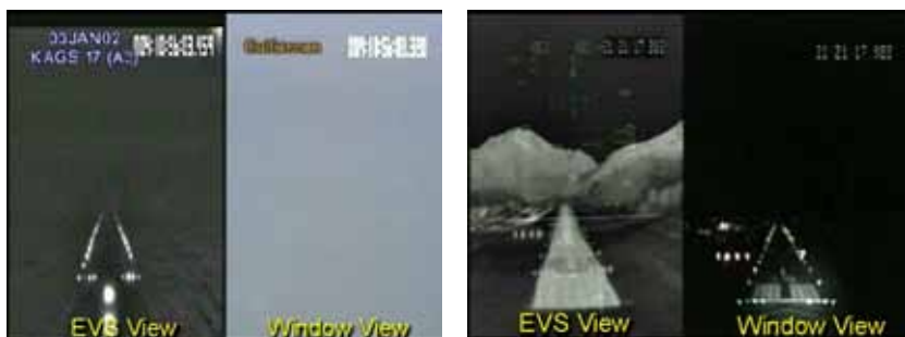
Рис. 13. Примеры работы системы Kollsman All Weather Window: EVS View — синтезированное изображение; Window View — вид из кабины пилота
