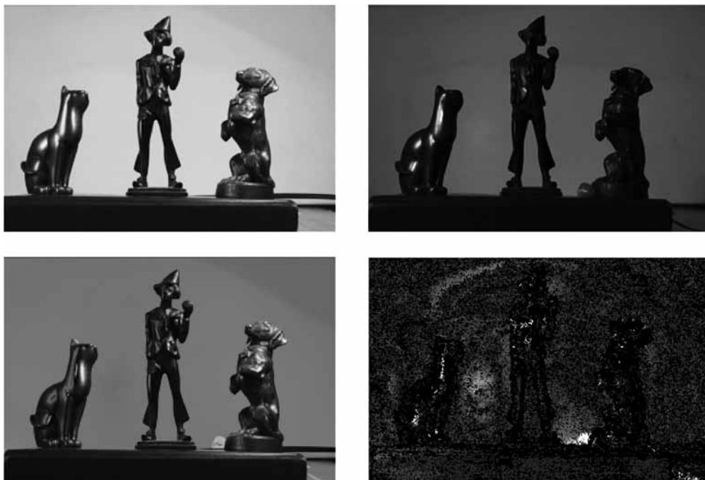
Рис. 7. Выделение отличий по форме. Слева сверху — изображение f , задающее форму изображения сцены. Справа сверху — изображение \xi сцены, отличающейся от предыдущей наличием детали — бусинки, лежащей у ног статуи собачки. Слева внизу — изображение, яркость которого равна разности яркостей изображений f и \xi , по этому изображению заметить отличие в сценах невозможно. Справа внизу — разность \xi - P\xi , хорошо видна область поля зрения, на которой показана бусинка, изменившая форму изображения сцены.
