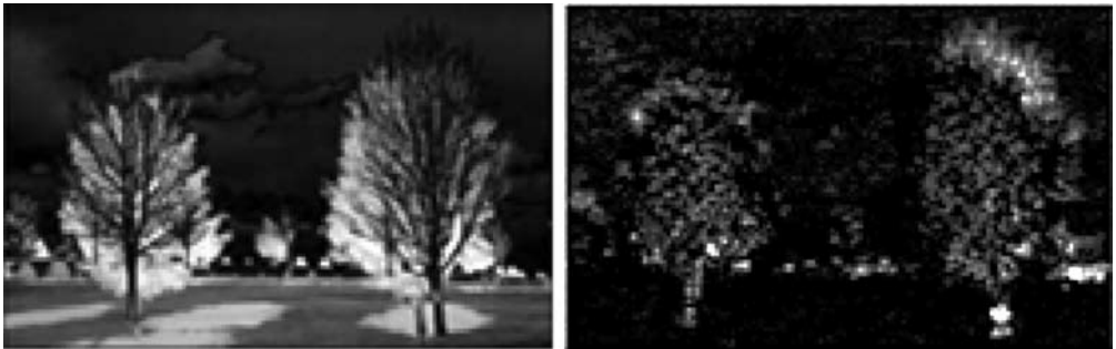
Рис. 2. Результат выделения отличий в сценах. Слева — разность f - g изображений, приведенных на рис. 1, справа — отличие изображения летнего пейзажа g от зимнего f по форме. Форму изображения f определяют конфигурации областей его одинаковой яркости. Отличие по форме получается вычитанием средней яркости P_f g изображения g на этих областях из яркости изображения g в каждой точке поля зрения. Отличные от нуля разности g - P_f g возникают вследствие изменения конфигураций областей поля зрения равной яркости изображения g по сравнению с конфигурациями соответствующих областей изображения f , которые вызваны изменением сцены
