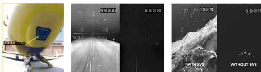
Рис. 14. Примеры работы системы Gulfstream EVS. Показаны изображения, формируемые EVS (with EVS), и вид из кабины пилота без EVS (without EVS)
