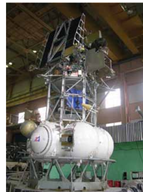
Рис. 1. Космический аппарат «Фобос-Грунт» на вибродинамических испытаниях
