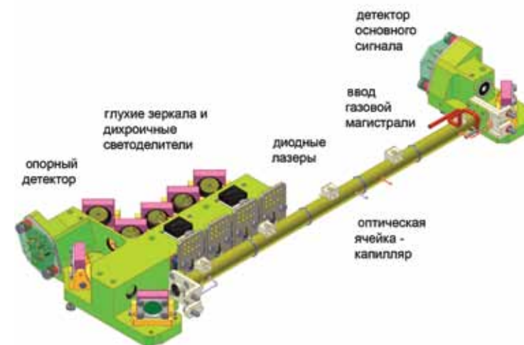
рисунок 11 Общий вид конструкции лазерного спектрометра ДЛС без блоков электронного управления
