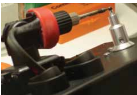
рисунок 3 Термическая герметизация цилиндрического контейнера в боксе, заполненном аргоном
