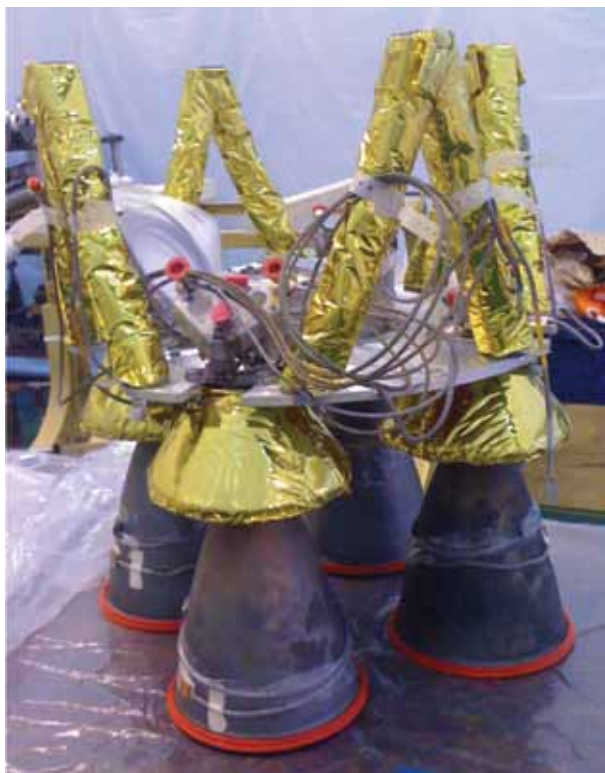
Рис. 9. Общий вид блока двигателей коррекции с агрегатами СОТР
