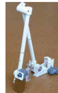
рисунок 1 Система технического зрения манипуляторного комплекса КА «Фобос-Грунт»
