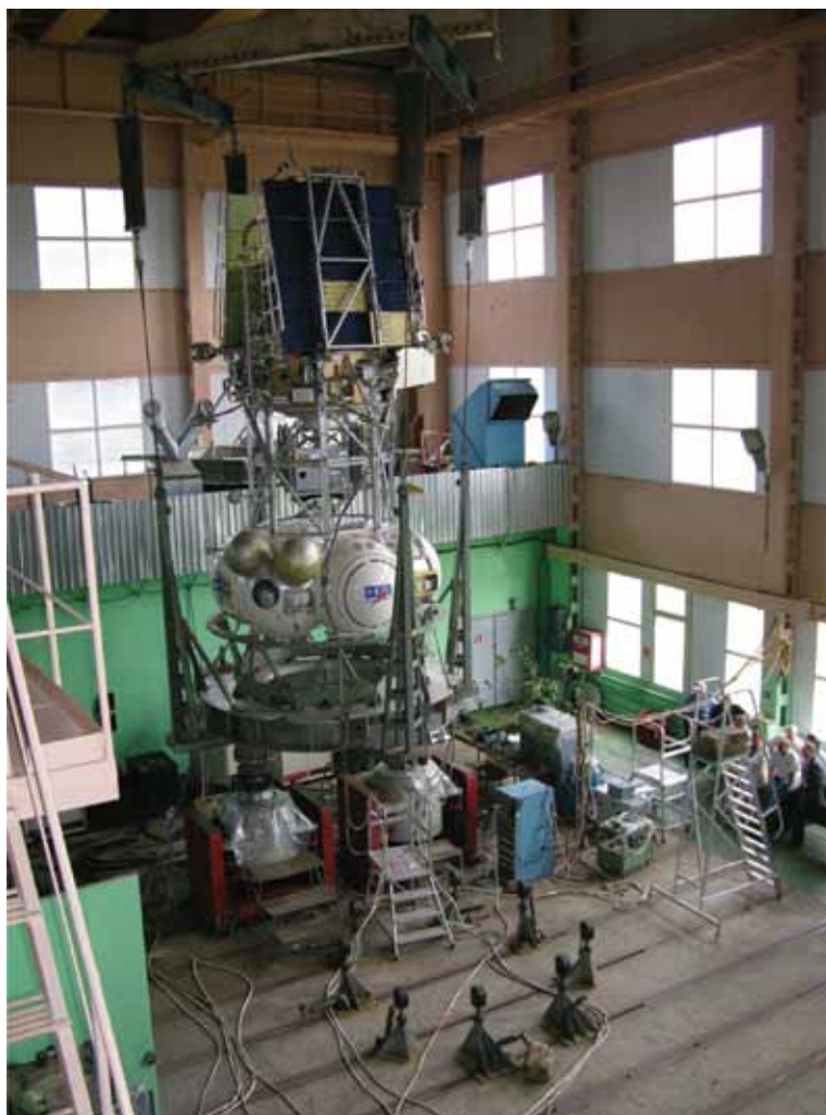
Рис. 1. Испытание на виброкомплексе V984LDS . Продольная ось
