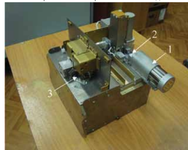
рисунок 4 Внешний вид прибора ТДА: 1 - устройство размельчения грунта СОПСИС; 2 - загрузочное отверстие; 3 - вывод капиллярных трубок в прибор ХМС-1Ф (под защитой)
