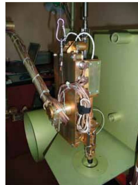
Рис. 3. Последнее звено манипулятора
