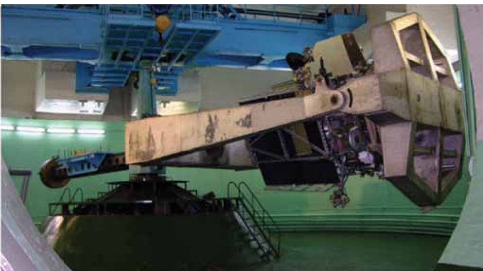
Рис. 3. Испытание перелетного модуля на центрифуге на случай максимальных продольных перегрузок
