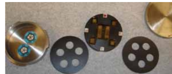
рисунок 5 Биомодуль в разобранном виде. Слева направо: титановое дно корпуса с двумя датчиками температуры, противоударная прокладка, нижняя часть носителя с термодатчиками и детекторами радиационного излучения (маленькие белые квадраты под защитной лентой Kapton), противоударная прокладка и титановая крышка корпуса
