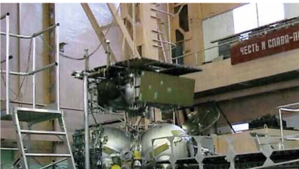
Рис. 4. Испытание на случай отделения возвращаемого аппарата от перелетного модуля
