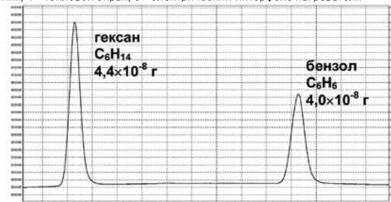
рисунок 9 Участок тестовой хроматограммы смеси легких углеводородов на колонке КК 2 . Соотношение сигнал/шум по бензолу ~600
