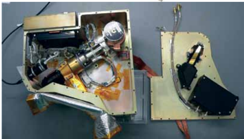
рисунок 3 Основные элементы ИК-микроскопа. Вверху – трехмерная модель. На переднем плане АОПФ-осветитель, излучение которого подается к предметному стеклу системой из двух зеркал. Прямо за предметным стеклом расположен объектив микроскопа и матричный детектор SOFRADIR с системой охлаждения. Внизу – общий вид оптического блока в разобранном виде. На откинутой панели расположены осветитель и его зеркала
