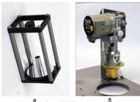
рисунок 5 Телескоп и детектор прибора ИИММ: а – зеркала телескопа [в окончательном варианте телескоп смонтирован в трубчатой конструкции - см. рисунок 4); б – матричный детектор с системой охлаждения SOFRADIR
