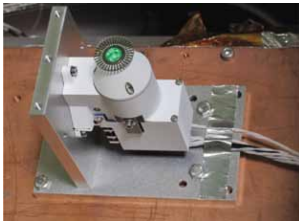
рисунок 1 Оптический микроскоп MicrOmega, подготовленный к термовакуумным испытаниям. На входном окне микроскопа установлена тестовая мира
