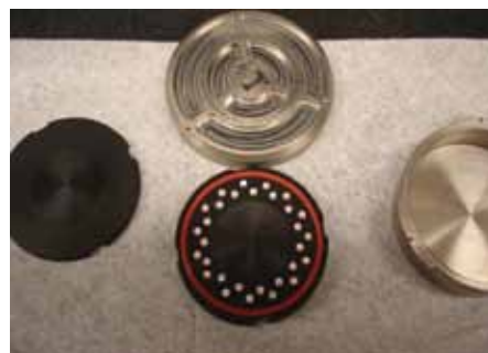
рисунок 4 Нижняя часть носителя из дельрина (в центре), с маркированными цилиндрическими контейнерами с образцами, и центральным контейнером с почвой; силиконовое уплотнительное кольцо; верх носителя (слева); титановая крышка (сверху); титановое основание (справа).
