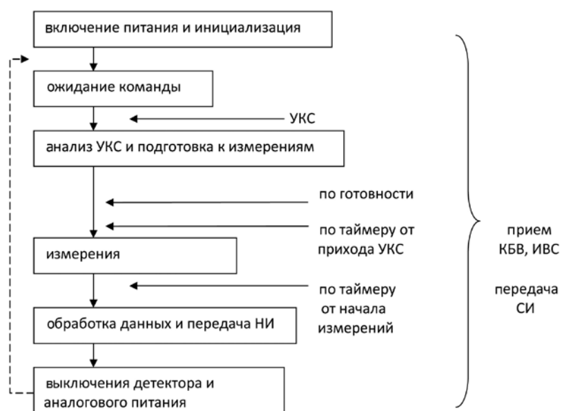
рисунок 10 Циклограмма работы прибора ТИММ: НИ – научная информация; СИ – служебная информация; УКС – управляющее командное слово; КБВ – код бортового времени; ИВС – информация о внешнем событии
