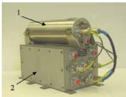
рисунок 17 Внешний вид прибора МАЛ-1Ф. Масс-анализатор – 1, блок электроники – 2
