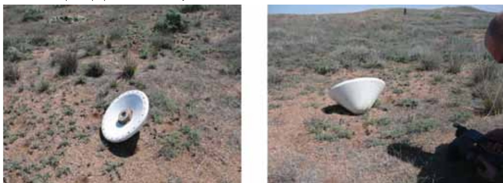
Рис. 7. Макет СА после сброса
