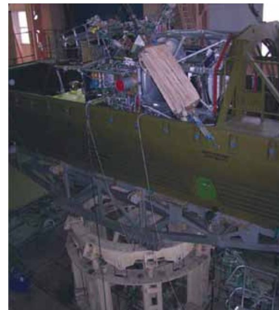
Рис. 2. Испытание на стенде кратковременных циклических нагрузок в транспортном контейнере на случай авиационной посадки
