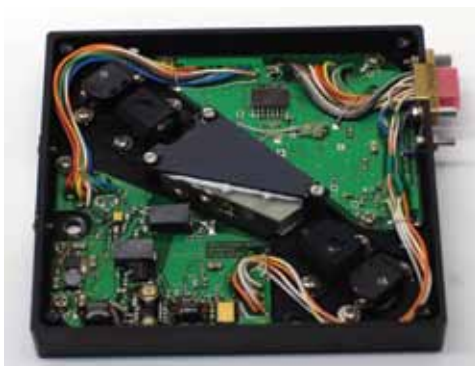
рисунок 6 Блок АОПФ со снятой крышкой. Кристалл АОПФ находится между объективами коллиматора; вокруг расположены электронные платы синтезатора и усилителя высокочастотного сигнала для активации АОПФ с элементами согласования
