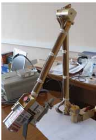
рисунки 5 Блок датчиков (МС-БД), установленный на манипуляторе
