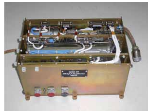
рисунок 6 Общий вид прибора ХМС-1Ф со снятой верхней крышкой
