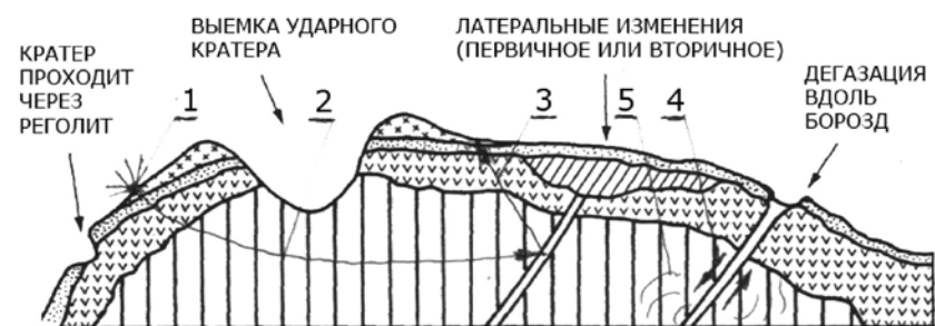
рисунок 2 Схема, иллюстрирующая возможные типы вертикальных и латеральных изменений состава: 1 – удар микрометеорита; 2 – прямая, рефрагированная волна от источника; 3 – волна, отраженная от борта сквозной трещины (борозды); 4 – относительное движение бортов трещины под действием приливных сил; 5 – излучение высокочастотных шумов при движении бортов 4
