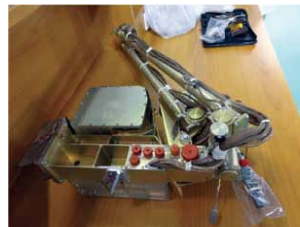
рисунок 5 Установка ИК-микроскопа на руке-манипуляторе 2
