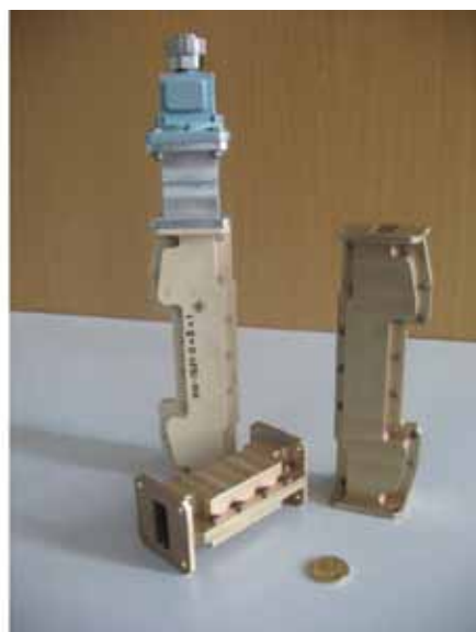
Рис. 6. Режекторные фильтры (вверху – приемного тракта, внизу – передающего тракта)
