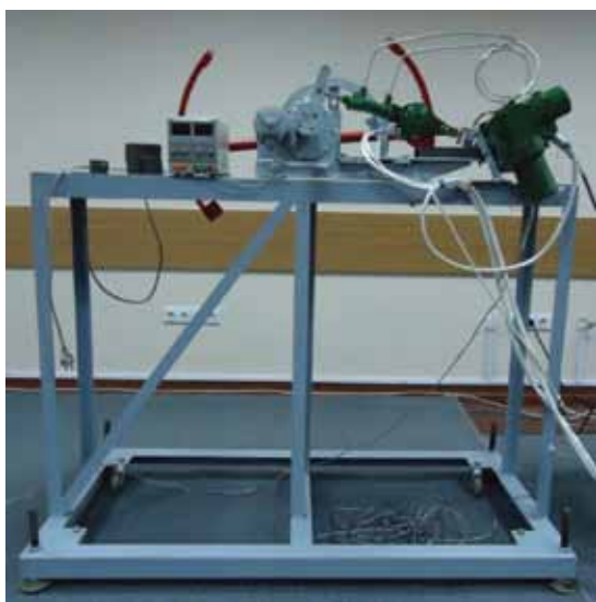
Рис. 5. Рулевая машина МДУ на нагрузочном стенде
