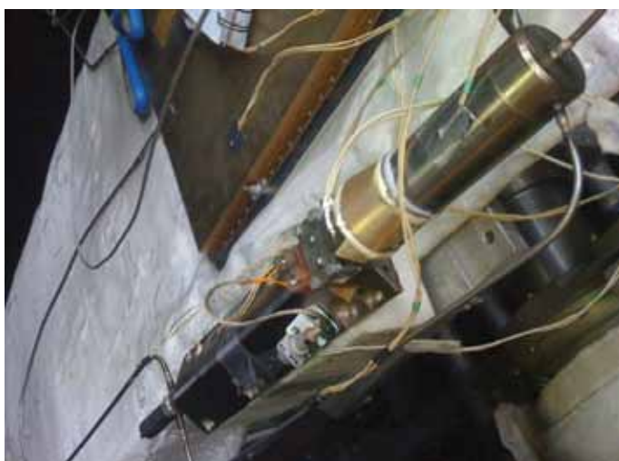
Рис. 5. Испаритель из состава теплопровода радиатора СОТР ТСП ПМ
