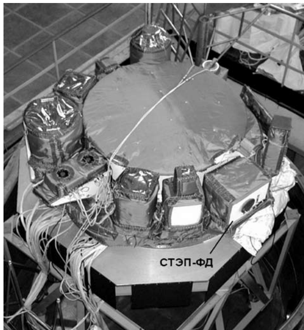
Рис. 3. Блок детекторов СТЭП-ФД технологического образца прибора во время проведения тепловакуумных испытаний в ФГУП «Научно-исследовательский институт электромеханики» (НИИЭМ), г. Истра
