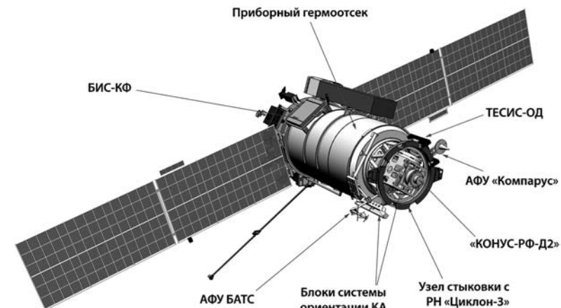
Рис. 2. Вид КА «КОРОНАС-ФОТОН» по оси +Z : ТЕСИС-ОД — оптические датчики (астродатчики) телескопа-спектрометра ТЕСИС (телескоп-спектрометр EUV-диапазона); «КОНУС-РФ-Д2» — детектор (антисолнечный) рентгеновского и гамма-спектрометра «КОНУС-РФ»; АФУ БАТС — антенно-фидерное устройство бортовой аппаратуры телесигнализации; АФУ «Компарус» — антенно-фидерное устройство бортовой аппаратуры командно-измерительной системы «Компарус-А2»; БИС-КФ — бортовая информационная система
