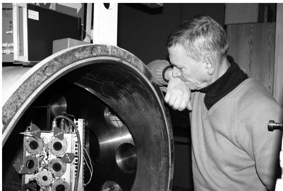
Рис. 7. Прибор БМСВ в одной из вакуумных камер ИКИ РАН перед проведением предстартовой калибровки с помощью пучка ионов, 2009 г.
