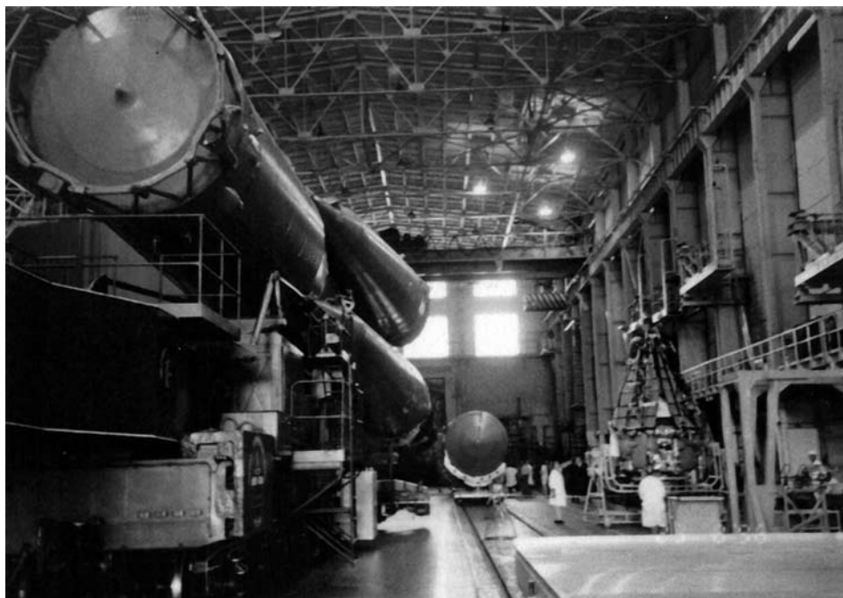
Ракета-носитель «Молния» подготовлена к стыковке с разгонным блоком и космическим аппаратом «Интербол-2». МИК КО космодрома Плесецк, 1996 г.
