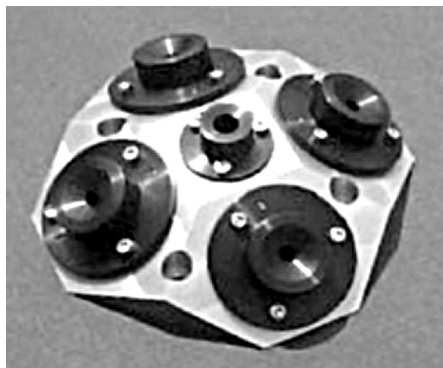
Модель усеченной фотоприемной пирамиды с пятым фотоприемником
