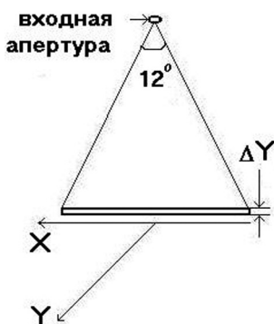
Рис. 1. Полоска поверхности Земли, проецируемая на вход фотоприемного устройства. Величина полоски по Y определяется углом 1' и высотой полета
