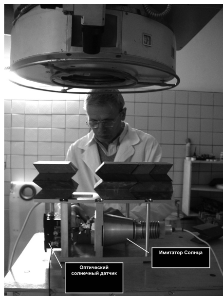
Рис. 8. Испытания ПЗС-линейки SONY ILX 703A в составе ОСД на гамма-установке
