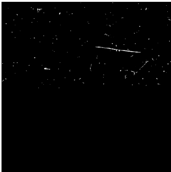
Рис. 1. Изображение, полученное с прибора БОКЗ после солнечной вспышки
