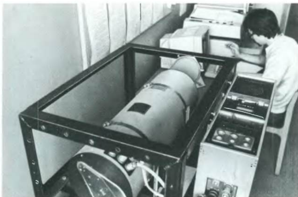
Использование бортовой технологической аппаратуры «Кристаллизатор ЧСК-1» в комплексе наземной обработки экспериментов, планируемых для выполнения на орбитальной станции
