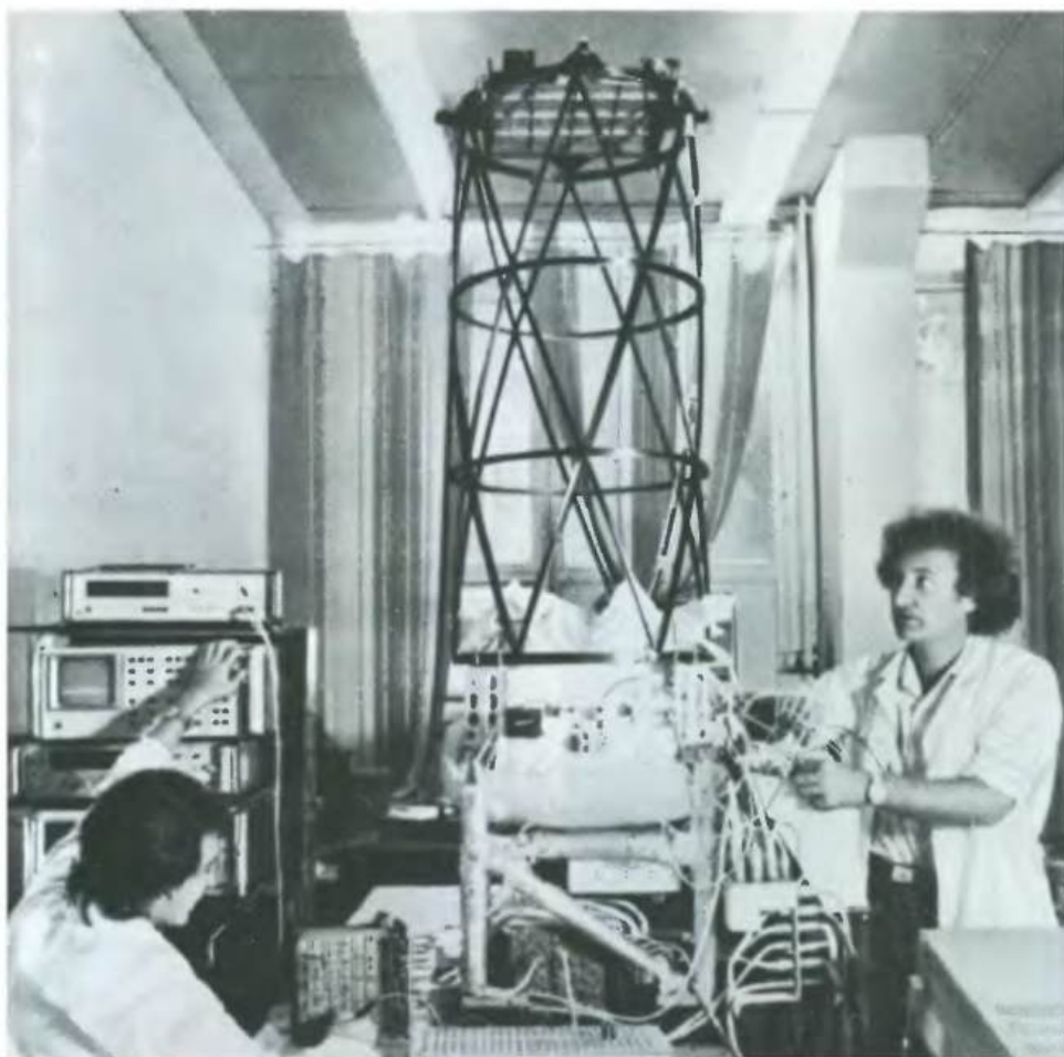
Подготовка телескопа АРТ-П к электрическим испытаниям
