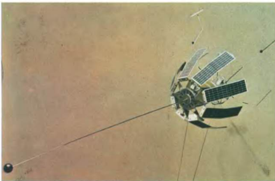
Один из спутников «Ореол». Выведенные на полярные орбиты, они позволили уточнить области и механизмы прямого проникновения солнечного ветра в магнитосферу
