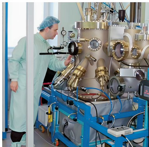
Рис. 3. Установка молекулярно-лучевой эпитаксии в ИФП СО РАН. В условиях сверхвысокого вакуума здесь слой за слоем, с атомарной точностью, выращиваются многослойные структуры будущих фотокатодов. © ИФП СО РАН
