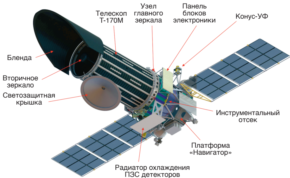
Рис. 9. Анатомия обсерватории: схематичное устройство космического аппарата «Спектр-УФ». Хорошо видны служебный модуль «Навигатор», телескоп Т-170М с комплексом научных приборов, а также солнечные батареи. © ИНАСАН
