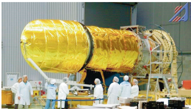
Рис. 7. Телескоп Т-170М в цехе АО «НПО Лавочкина». Золотистая многослойная термоизоляция (так называемая «золотая фольга») защитит телескоп и его оптику от перегрева и переохлаждения. © АО «НПО Лавочкина»
