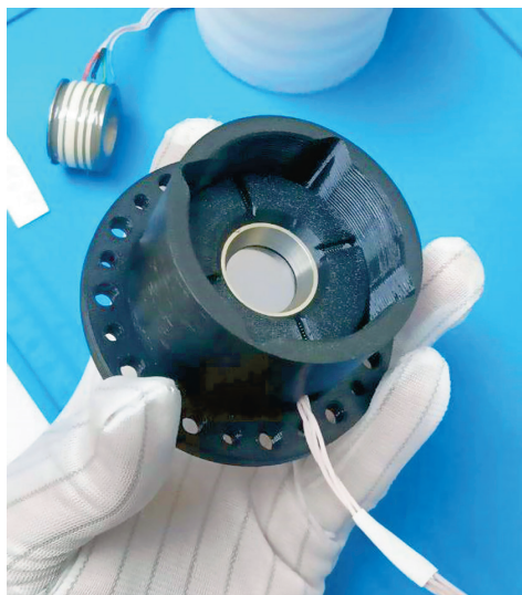
Рис. 6. Собранный «глаз» телескопа. Прототипы электронно-оптических преобразователей, изготовленные в ИФП СО РАН. В вакуумном корпусе собраны воедино фотокатод, микроканальная пластина и экран – ключевые элементы для регистрации ультрафиолетовых изображений. © ИНАСАН
