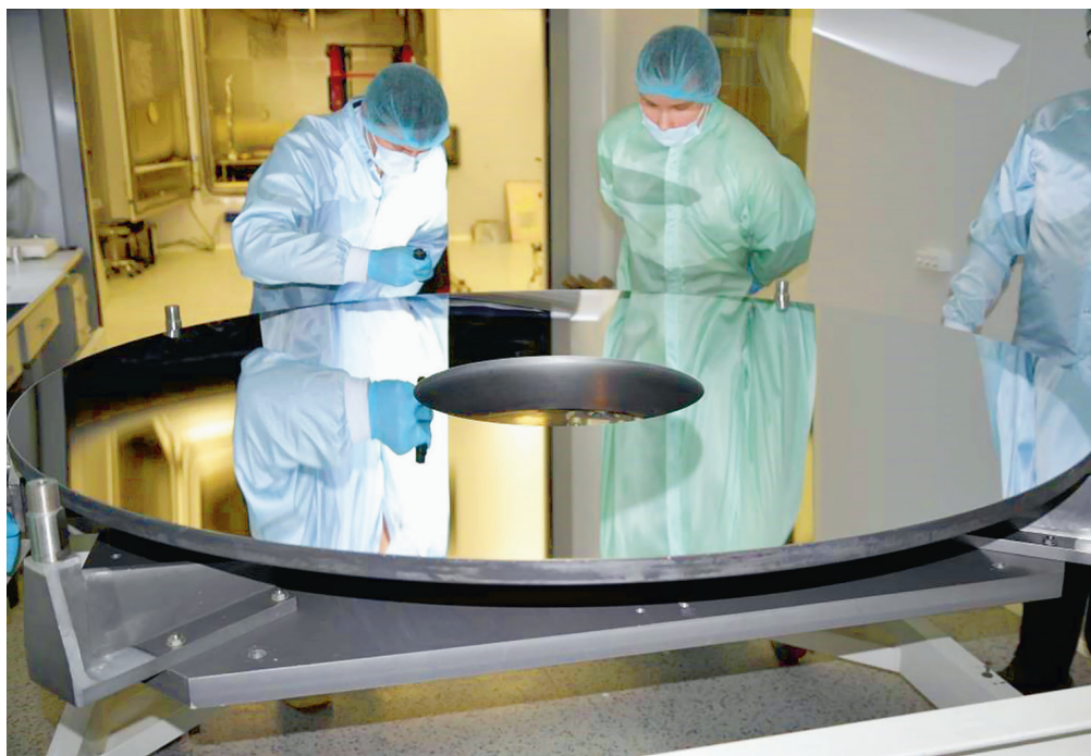
Рис. 2. Ювелирная работа. Контроль поверхности главного зеркала телескопа в АО «НИИ НПО «Луч»» (вверху). Специальное покрытие, нанесенное в вакуумной камере, должно обеспечить максимальное отражение ультрафиолетового света и выдержать годы в космосе. © ИНАСАН
