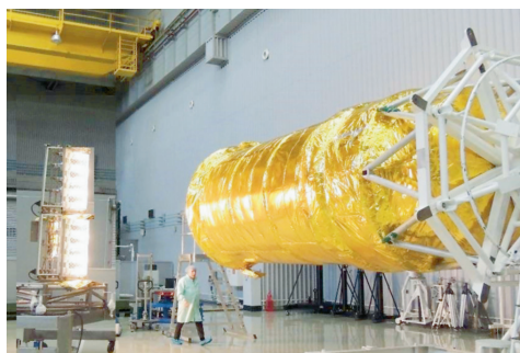
Рис. 8. Проверка на абсолютную темноту. Телескоп на стенде для испытаний светогерметичности. Любая, даже самая слабая засветка извне способна испортить наблюдения слабых звезд. Инженеры проверяют, насколько хорошо конструкция защищает внутренний объем от внешнего света. © АО «НПО Лавочкина»
