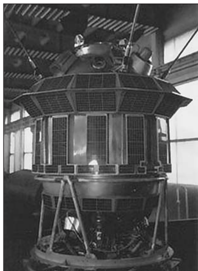
Космический аппарат «Луна-3», впервые сфотографировавший обратную сторону Луны.
