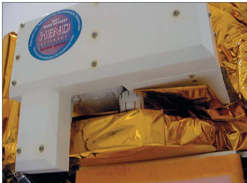
Рис.5. Прибор HEND на борту космического аппарата «Mars Odyssey» за 20 дней до старта.
