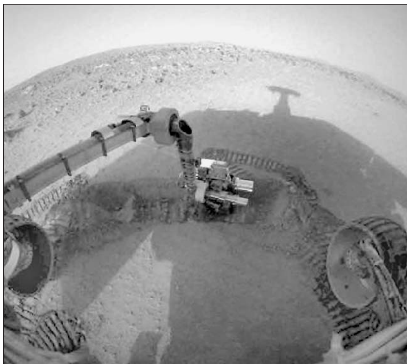
Рис.6. Мёсбауэровский спектрометр анализирует грунт в борозде, прорытой колесами марсохода «Spirit» в районе Лагуны Холлоу. Снимок сделан служебной камерой «HAZCAM», предназначенной для предотвращения нештатных ситуаций, 21 февраля 2004 г. (NASA/JPL/Cornell.)
