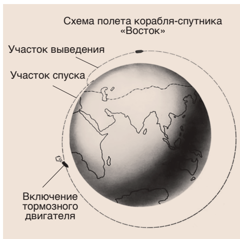
Схема полета корабля-спутника «Восток». РГАНТД. Ф 107. Оп. 2. Д. 190
