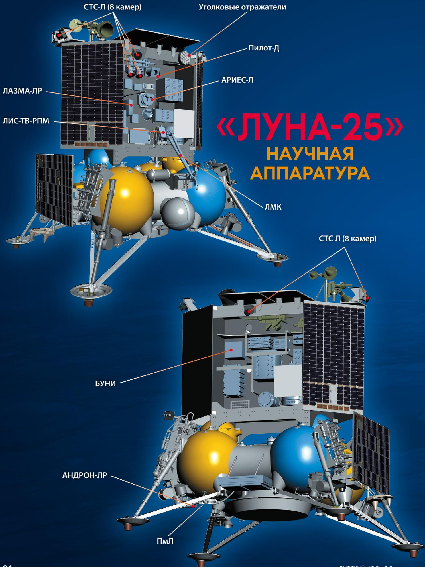
**АДРОН-ЛР** – Изучение элементного состава и содержания водорода в реголите методом активной нейтронной гамма-спектроскопии (ИКИ РАН) **6.2 кг**
