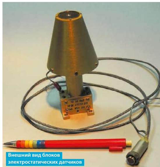
Внешний вид блоков электростатических датчиков
