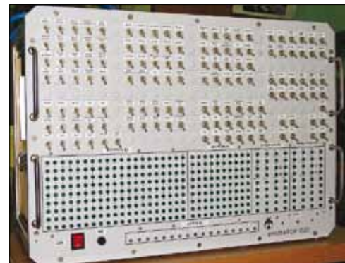
Имитатор ОСО для имитации общесамолётного оборудования в составе стендов отработки бортовых приборов самолёта Су-30
