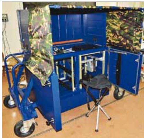
Мобильный модуль (ММ-СНК-135) для размещения аппаратуры системы наземного контроля радиолокационной станции военного самолёта. Обеспечивает защиту аппаратуры и оператора от воздействия внешних факторов окружающей среды (ветер, осадки)
