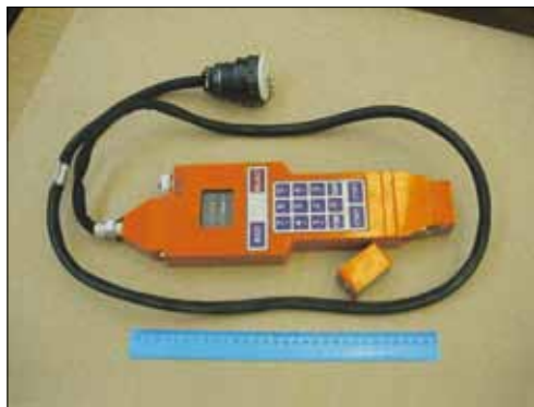
Бортовые комплексы СУСПД различных модификаций используются в составе аппаратуры привязных аэростатов различной высотности и назначения. Выполняют функции сбора и передачи данных о состоянии привязного аэростата, управления его агрегатами и полезной нагрузкой в автоматическом режиме и по командам с земли
