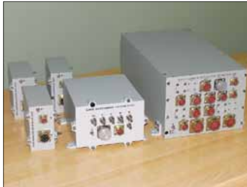
Бортовые комплексы СУСПД различных модификаций используются в составе аппаратуры привязных аэростатов различной высотности и назначения. Выполняют функции сбора и передачи данных о состоянии привязного аэростата, управления его агрегатами и полезной нагрузкой в автоматическом режиме и по командам с земли
