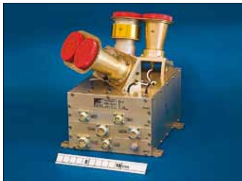
Прибор МЭП (монитор электронов и протонов) MEP (Monitor for Electrons and Protons)
