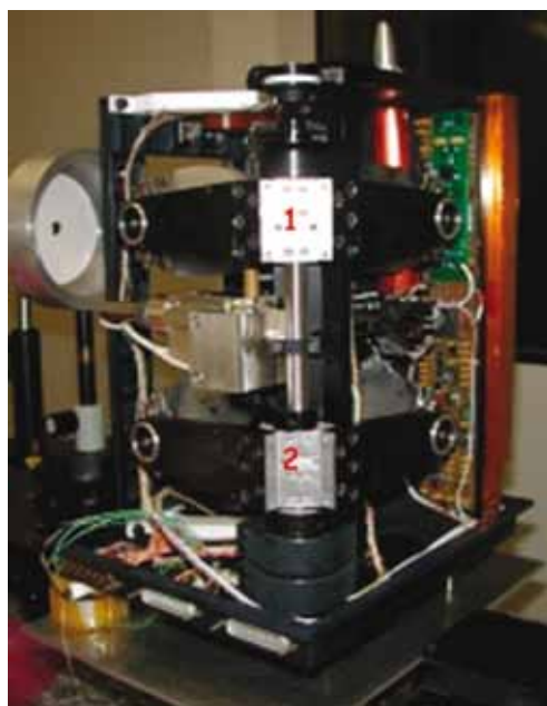
Планетный фурье-спектрометр для КА «Марс-Экспресс»: блок интерферометра, 1 и 2 — интерферометры длинноволнового и коротковолнового каналов соответственно
