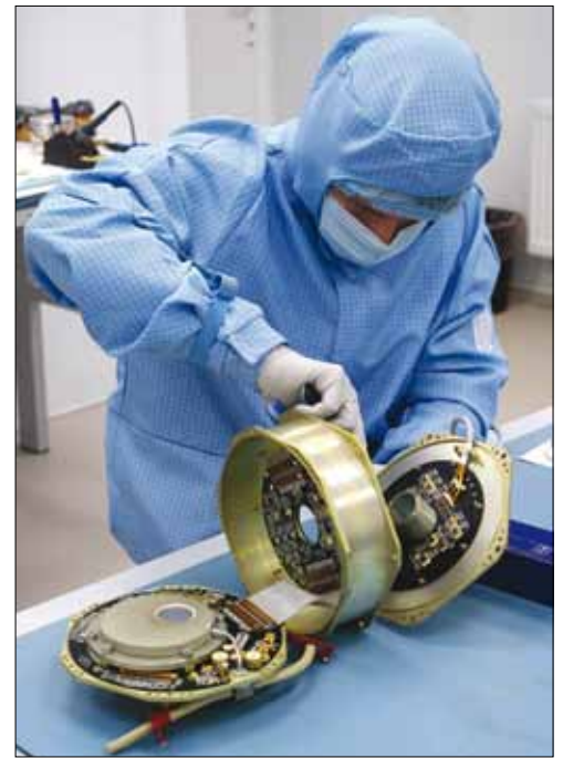
Сборка детектора телескопа ART-XC
