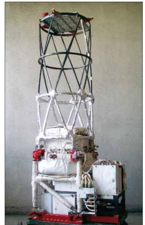
Один из модулей телескопа с кодирующей апертурой АРТ-П обсерватории «Гранат» One of the modules of the ART-P coded aperture telescope aboard Granat observatory
