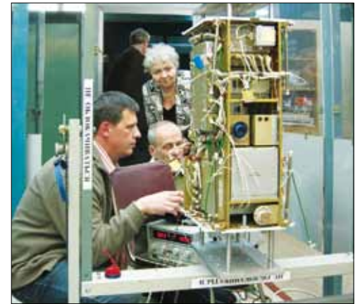
Программирование цифровой фотокамеры (ЦФК) микроспутника «Чибис-М»
