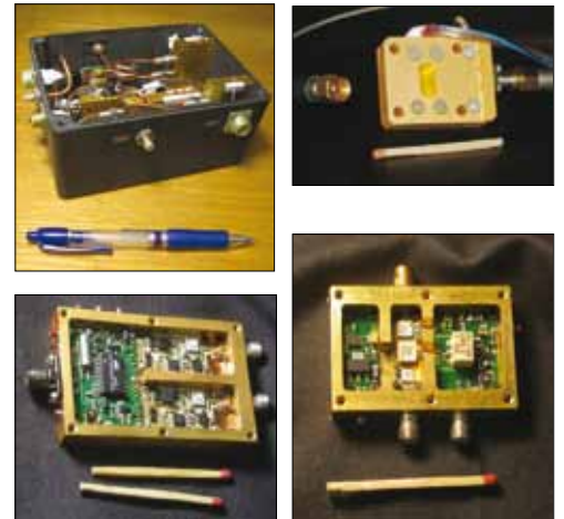
Аппаратура, созданная по проекту «РадиоАстрон»: приёмник в диапазоне 18–25 ГГц, малошумящий усилитель, двойной синтезатор, преобразователь частоты
