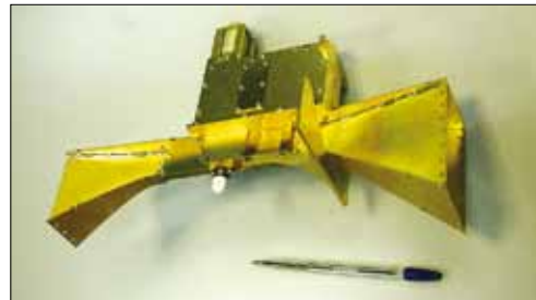
Макетный образец прибора РАТ-М для изучения марсианского грунта и атмосферы Марса с борта посадочной платформы в рамках проекта «ЭкзоМарс» (2018). В лаборатории ведётся разработка методики эксперимента и создание прибора — СВЧ-радиометра, работающего в диапазоне от 10 до 17 ГГц. Основная цель эксперимента — оценка тепловых вариаций температуры марсианского реголита и измерение плотности пыли в атмосфере Марса во время пылевых бурь
