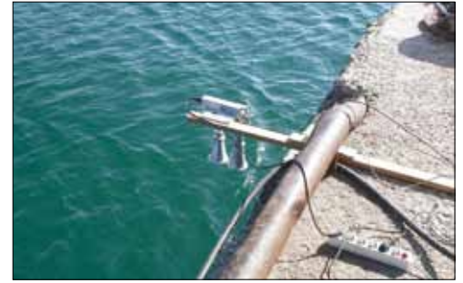
Радиофизические измерения в Голубой бухте (Геленджик) с помощью когерентного радара миллиметрового диапазона длин волн для дистанционного зондирования атмосферы и морской поверхности. Слева — результаты измерений, которые демонстрируют наличие волн с длительным периодом (порядка 10 мин)
