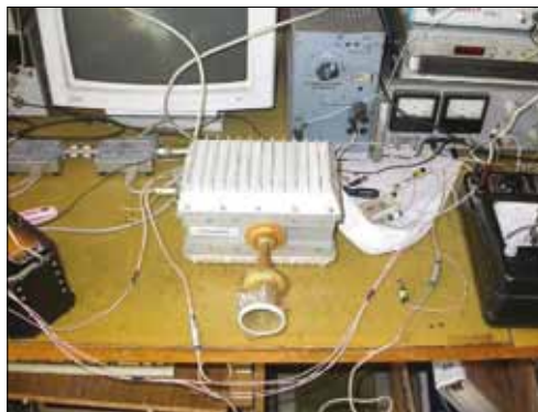
Аппаратура, созданная по темам «Оперетка» и «Бронепоезд» (государственный оборонный заказ). Целью работы было создание прибора «Обнаружитель», который состоял из пассивного канала — приёмник (слева), и активного — радиолокатор (посередине). Справа — лабораторные испытания прибора на крыше ИКИ РАН
