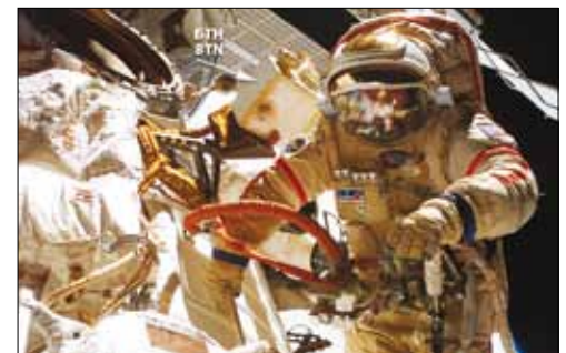
Астронавт НАСА Майкл Лопес-Алегрия устанавливает внешний регистрационный блок аппаратуры БТН-М1 на внешней поверхности модуля «Звезда» Российского сегмента МКС. Фото российского космонавта-участника эксперимента БТН-М1 Михаила Тюрин
