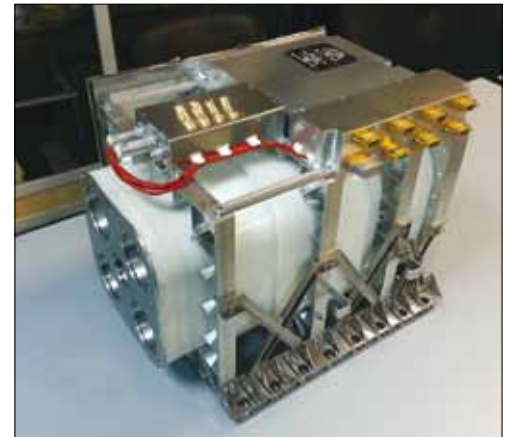
Общий вид лётного образца марсианского нейтронного телескопа ФРЕНД (вверху) и установка лётного образца ФРЕНД на борт КА ЕКА TGO (внизу)
