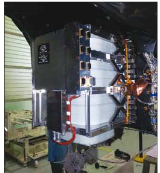
Общий вид лётного образца марсианского нейтронного телескопа ФРЕНД (вверху) и установка лётного образца ФРЕНД на борт КА ЕКА TGO (внизу)
