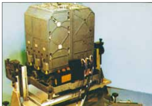
Многозональный фотоаппарат МКФ-6 и многозональный синтезирующий проектор МСП-4 для наземной обработки снимков, подготовленные для пилотируемого космического корабля «Союз-22» на народном предприятии «Карл-Цейсс Йена», ГДР, по техническому заданию ОФО ИКИ
