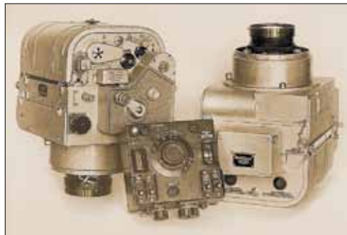
Аэрофотоаппараты АФА БА-210, адаптированные для установки на станцию «Салют» Aerial photo cameras AFA BA-210 modernized for the Salyut station
