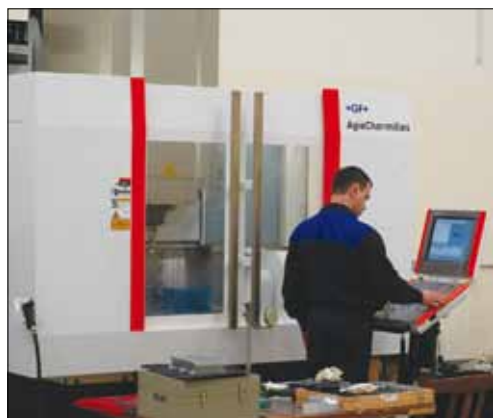
Новый фрезерный обрабатывающий центр UCP 800 DURO в работе
