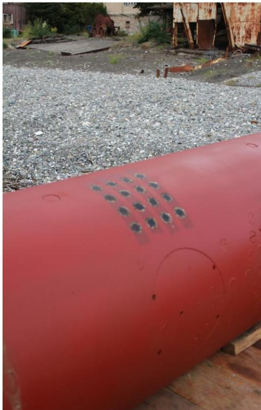
Измерения пристеночных турбулентных давлений выполняются в различных точках измерительной секции двумя типами пьезокерамических преобразователей давления: 1) стержневые (трубчатые) датчики глубиной около 15 мм и приемной поверхностью диаметром 1.3 мм и 2) пластинчатые датчики толщиной около 1 мм с диаметром приемной поверхности 20 мм.
