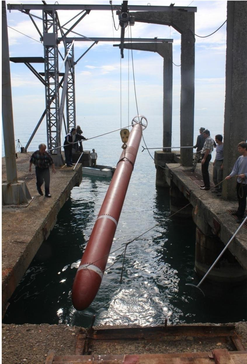
Турбулентные пульсации давления на поверхности всплывающего устройства во время его движения, регистрируют приемники, встроенные в обтекаемое тело
