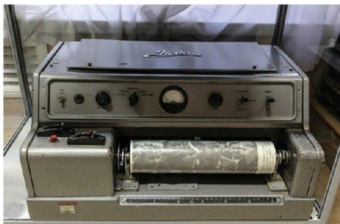
Рисунок 1.2 – Фототелевизионное устройство ввода изображений в ЭВМ БЭСМ-4 на базе фототелеграфного аппарата «Нева»
