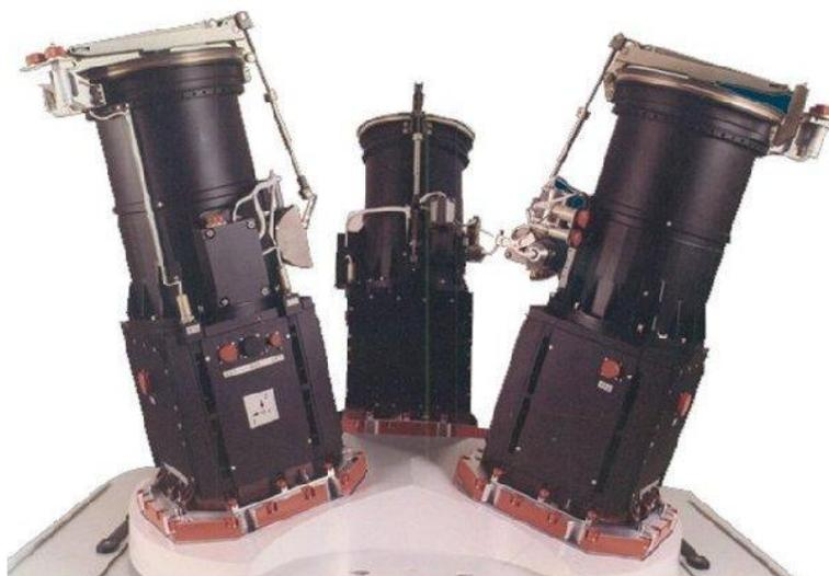
Рисунок 1.3 - Система оптических звездных датчиков «Астро»
