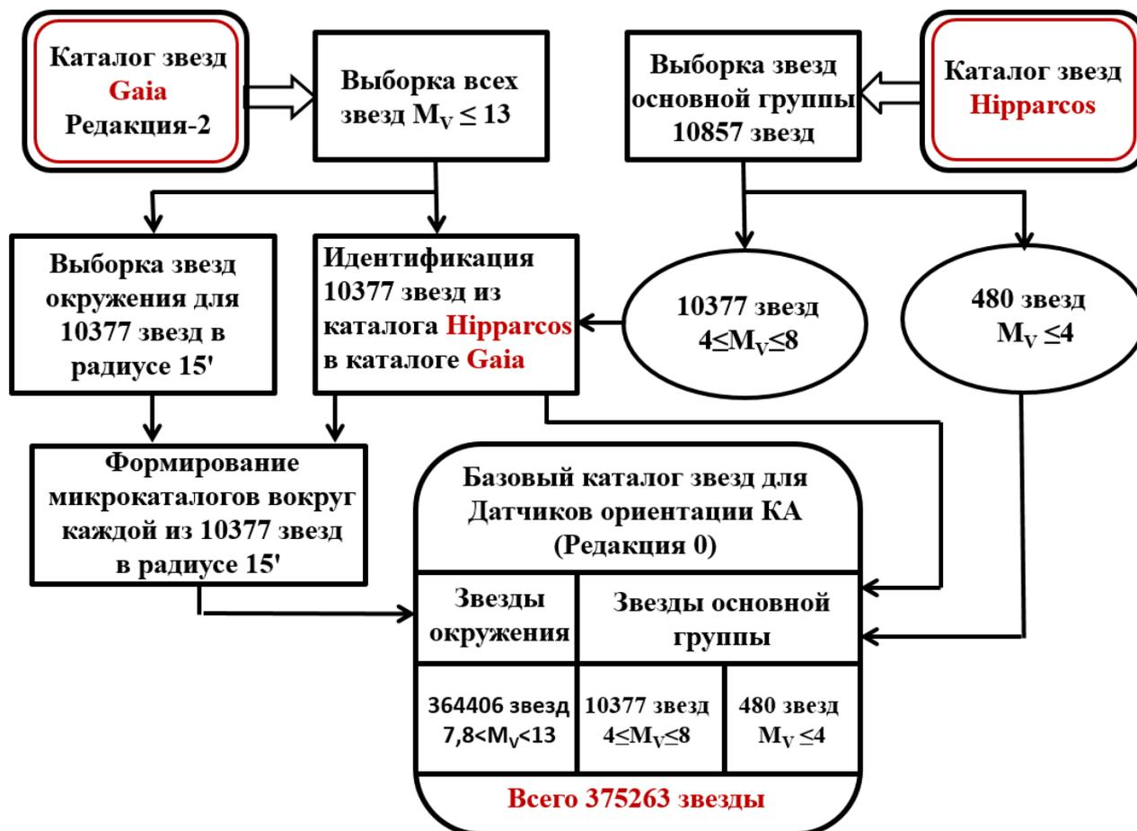
Рисунок 1.10 – Иллюстрация принципов формирования «Базового каталога звезд для датчиков ориентации КА»
