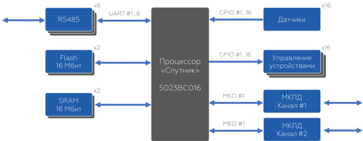
Рисунок 4.2 - Организация взаимодействия системы управления с научными приборами
