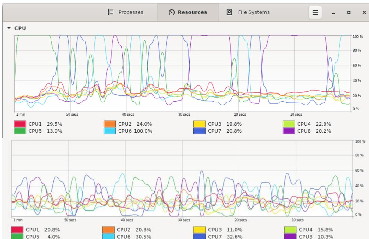
Рисунок 5.11 - Загрузки ядер процессора Rockchip RK3588S для стандартной схемы передатчика (верхний график), и для специального модуля «*IESS308 encoder (packed byte) with QPSK*» (нижний график)
