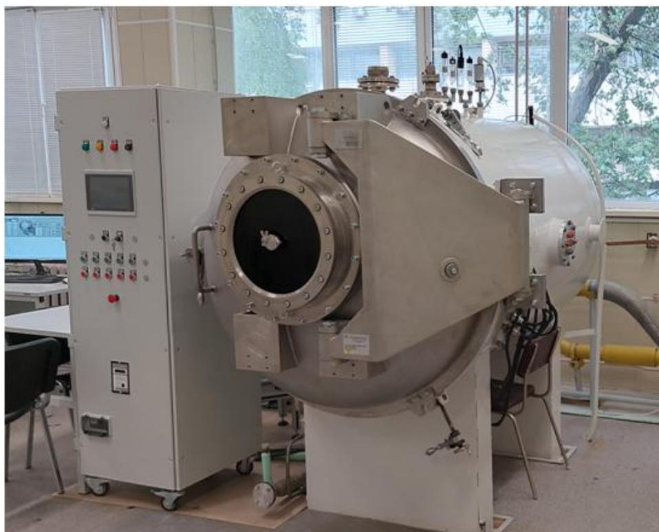
Рисунок 3.66 - Внешний вид вакуумной камеры ТВУ-2,5Г/1,5-0,6 (справа) и шкафа управления вакуумным оборудованием (слева)
