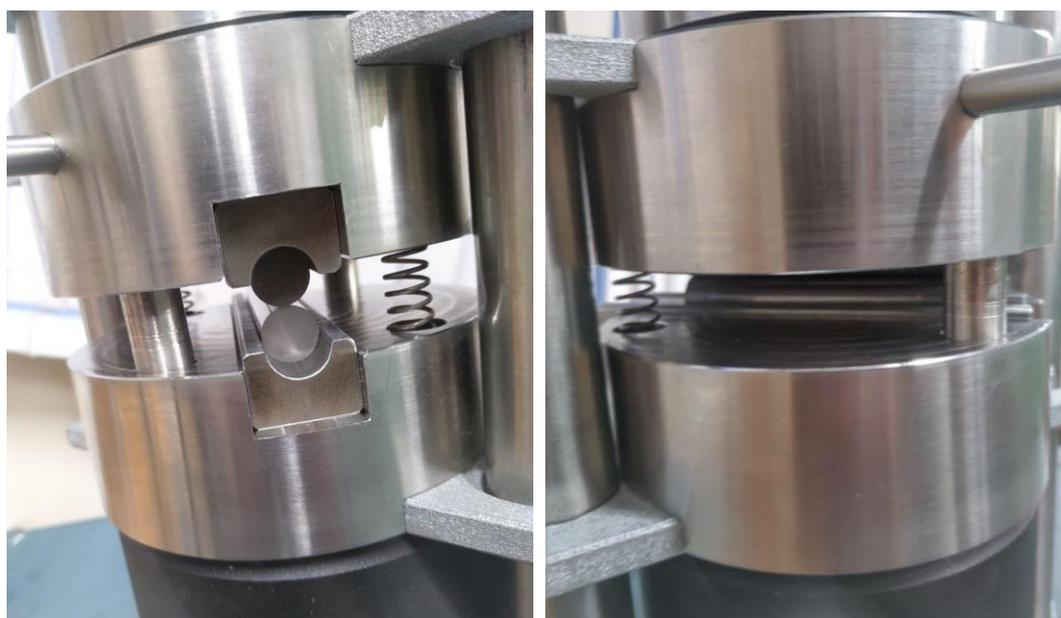
Рисунок 3.16 – Внешний вид гидравлического пресса и оснасти для обжима АМКП
