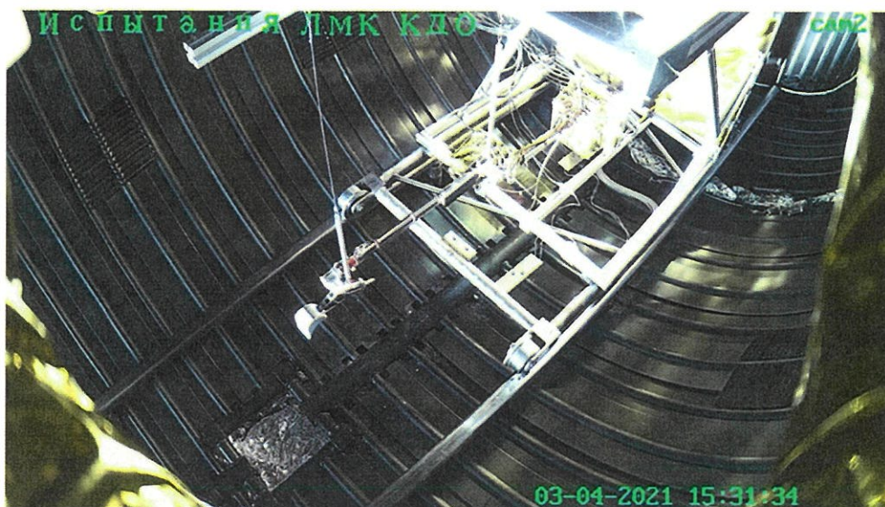
Рисунок 2.1 Размещение ЛМК в термовакуумной камере с имитатором Солнца
